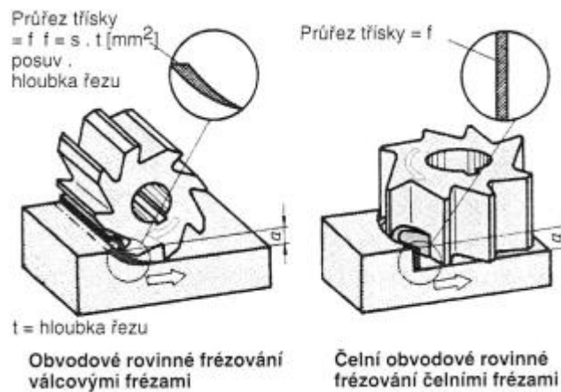
Obr. 1. Způsoby frézování [5]
