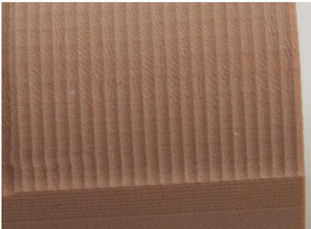
Obr. 93. Detail skutečné obrobene plochy
