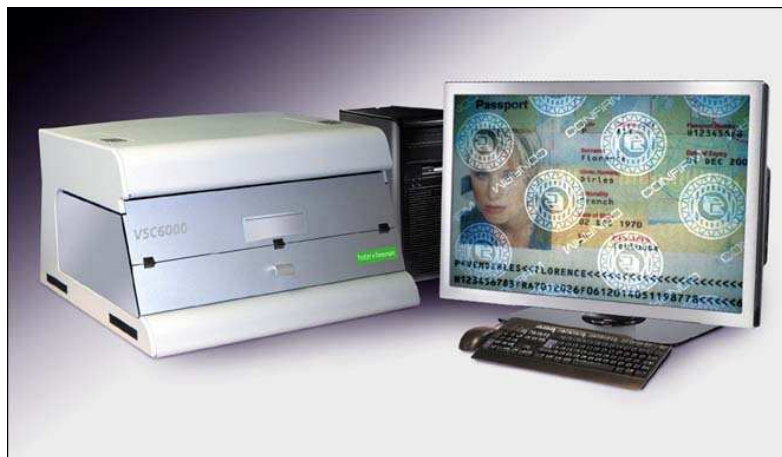
Obr. 34. Videospektrální komparátor VSC 6000 [16]
