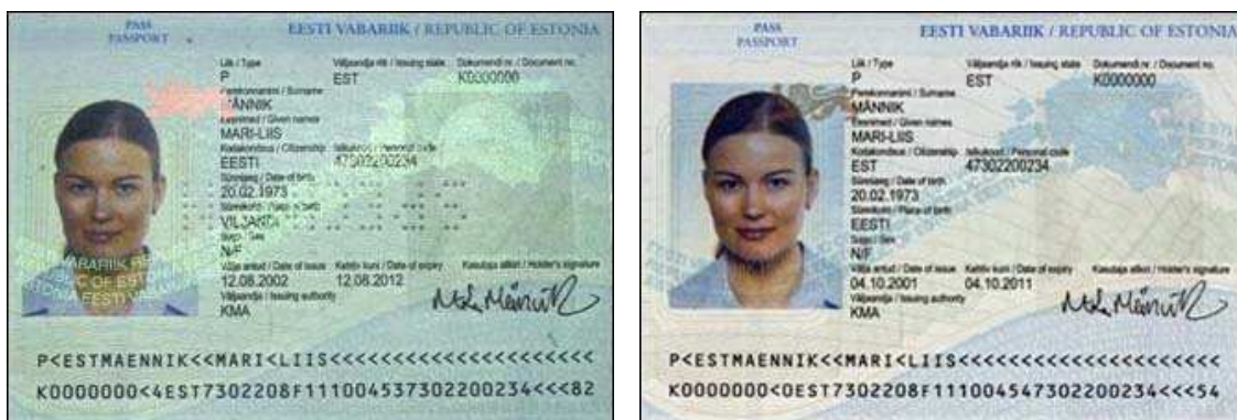
Obr. 29. Ukázka potisku fólie fotochromatickou barvou (Estonsko - cest. pas) [14]
