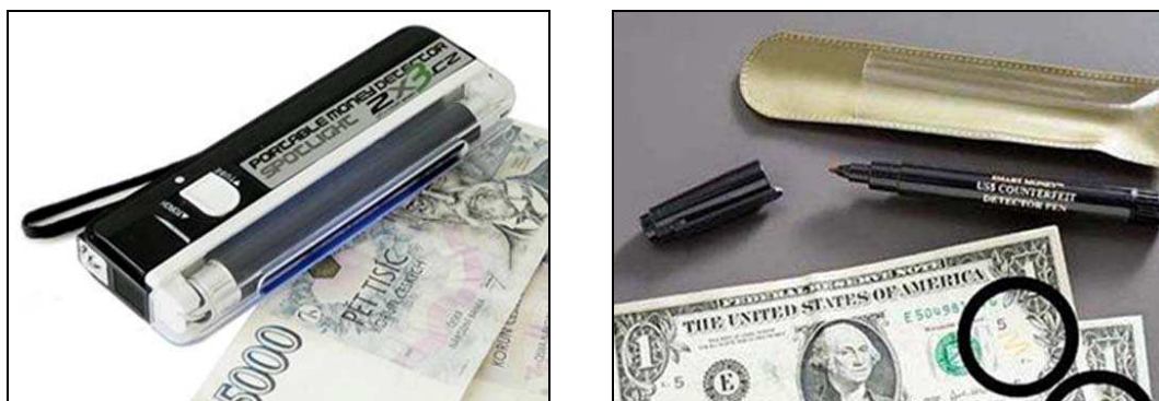
Obr. 32. Ruční UV detektor a testovací pero bankovek [15]
