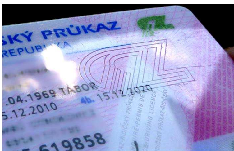
Obr. 22. Vnitřní laserové gravírování na řidičském průkazu ČR
