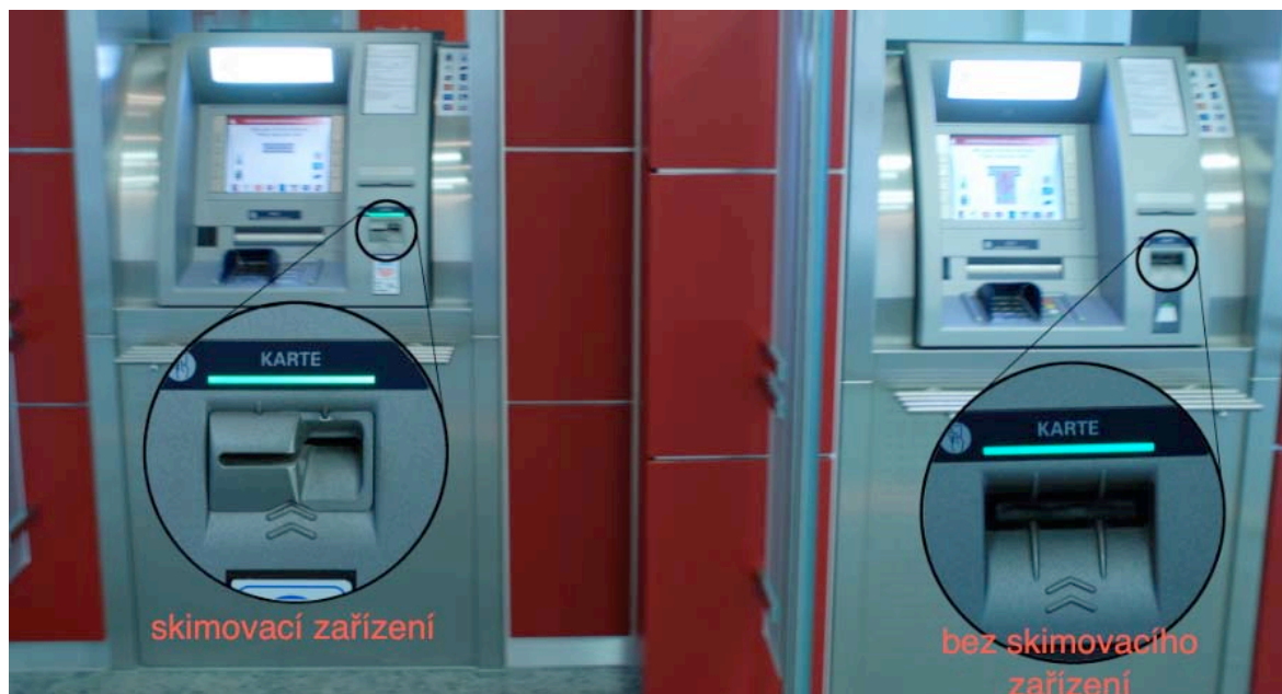
Obr. 31 Vlevo bankomat se skimovacím zařízením a vpravo bez něj [21]
