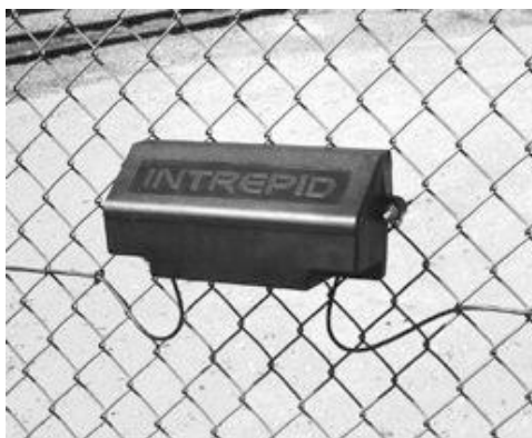
Obr. 29 Detekční senzor plotového systému Interpid. [12]
