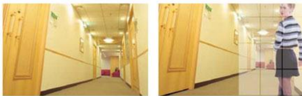
Obr. 39 Detekce pohybu u kamer porovnáním záběrů. [17]
