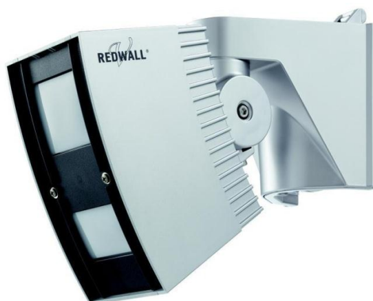
Obr. 12 PIR detektor OPTEX REDWALL SIP – 404 [12]
