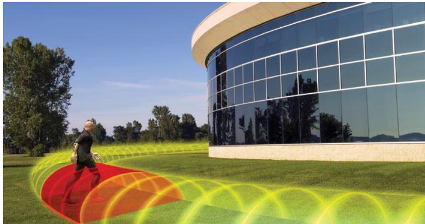
Obr. 37 Zemní perimetrický systém Micropoint. [12]
