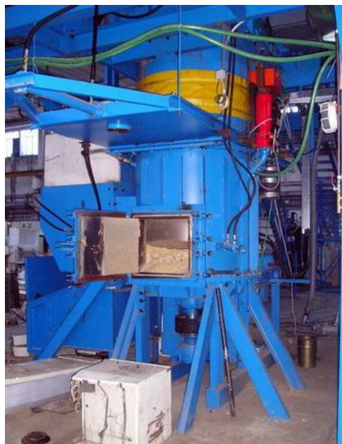
Obr. 23 Otevřený bubnový drtič [23]
