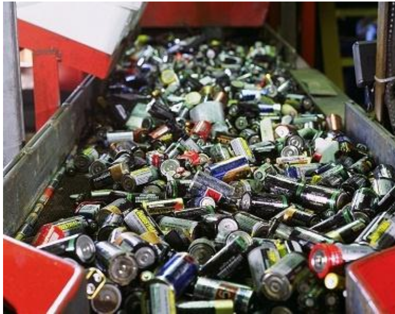
Obr. 15 Linka na recyklaci baterií [21]
