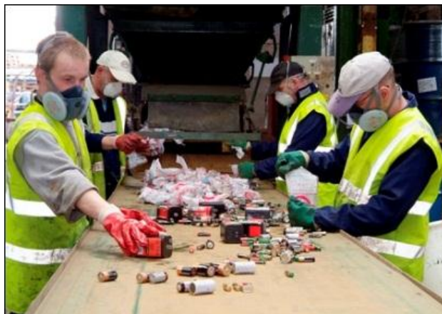
Obr. 16 Třídění baterií podle typů [20]
