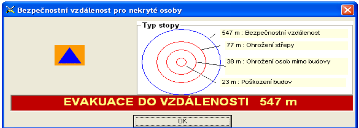
Obr. 2. Grafické vyhodnocení bezpečné vzdálenosti u uložení NVS v programu TerEx s 6,45 kg Hexogenu.
