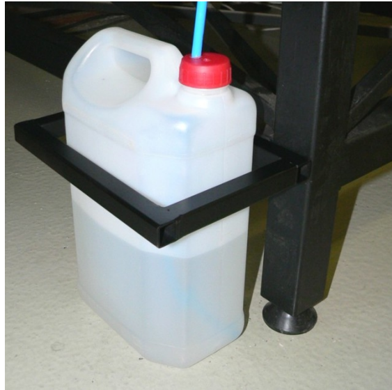
Obr. 35 Nádoba na emulzní kapalinu a její uchycení ke stroji
