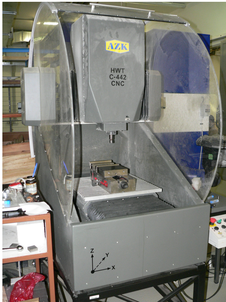
Obr. 25 Univerzitní CNC frézka HWT 442 bez systému chlazení
