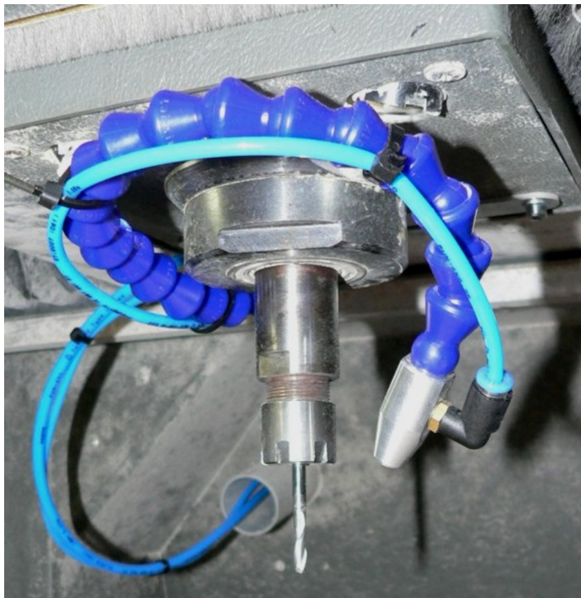
Obr. 32 Přesný přívod chladicí řezné mlhy do místa řezu
