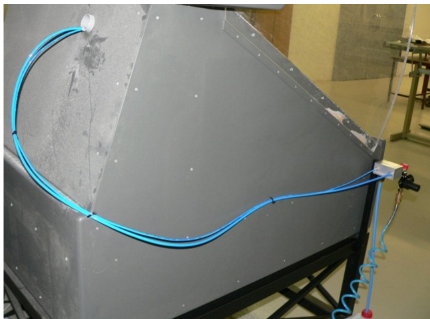
Obr. 36 Rozvod chladícího média
