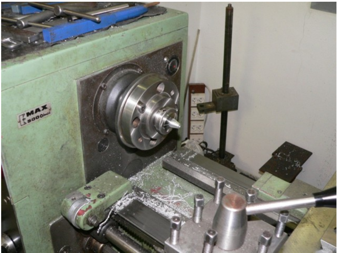
Obr. 38 Výroba trysky č. 2 na hrotovém soustruhu
