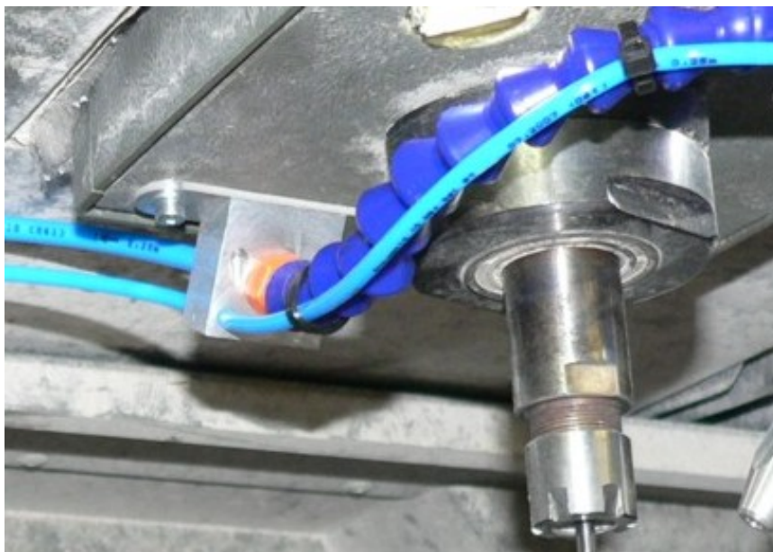
Obr. 33 Uchycení kloubové hadice LI-NOX ke stroji
