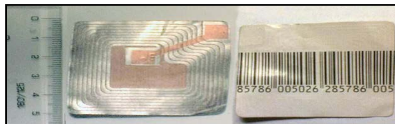
Obr. 5: Pasivní transponder obohacený o 1D čárový kód [14]
