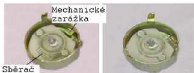
Obrázek 18: Mechanický doraz v tělese potenciometru [18]
