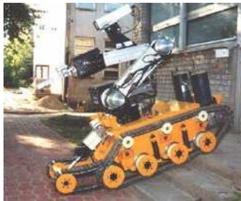
Obrázek 7: Robot s manipulačním ramenem, s pomocnými pásy, pro revizi potrubí [3],[4],[5]
