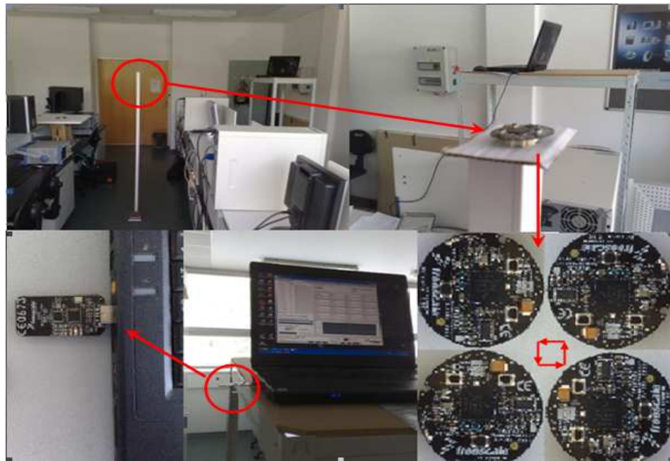
Obr. 24. Umístění vysílače na měřícím bodu 18 + statické umístění přijímače
