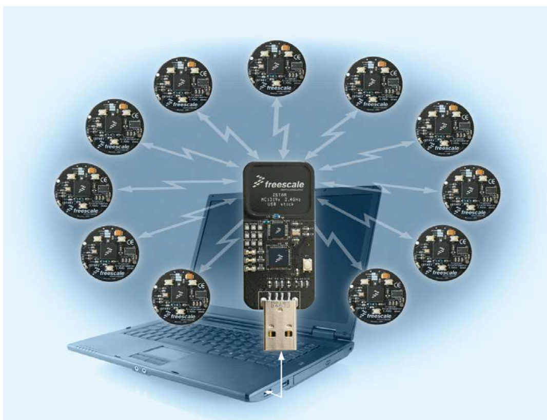
Obr. 5. Příklad hvězdicovou topologie v provedení ZigBee modulu ZSTAR3 [4]
