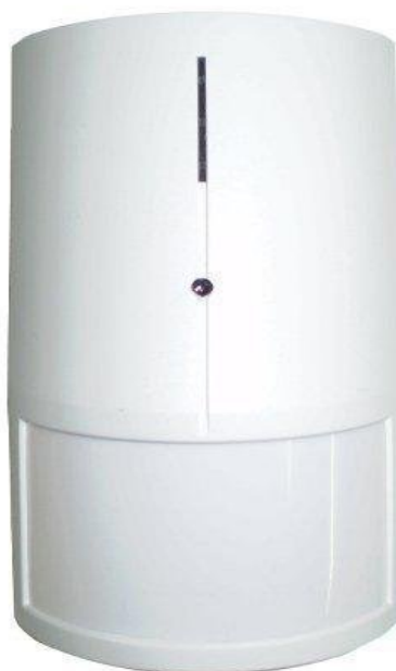
Obr. 19 Maskovaná kamera v PIR Jablotron JS-20 [22]
