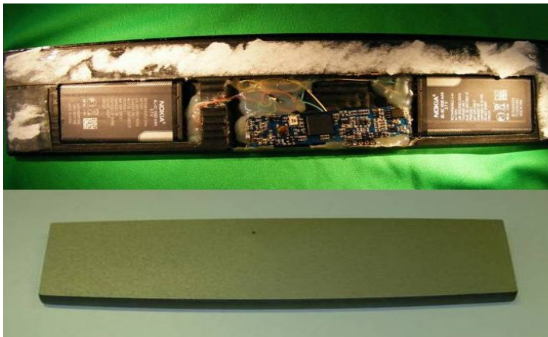
Obr. 17 Falešný panel bankomatu s kamerou pro snímání PIN kódu [20]
