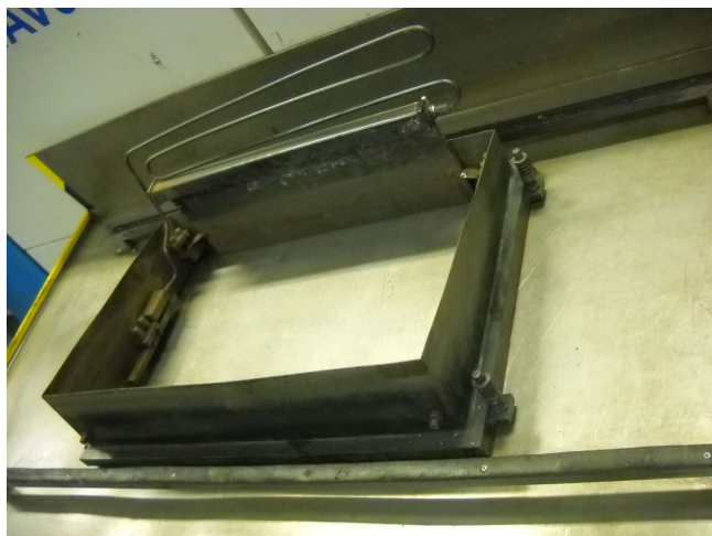
Obrázek 19: Rám v cínové lázni pájecí vlny WAV 9 (vlastní zdroj)
