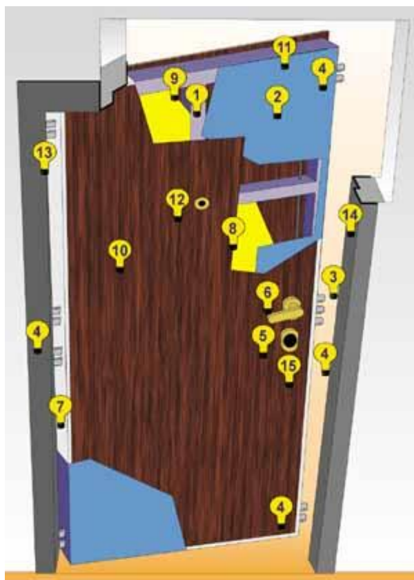
Obr. 38. Bezpečnostní dveře do původní zárubně.
