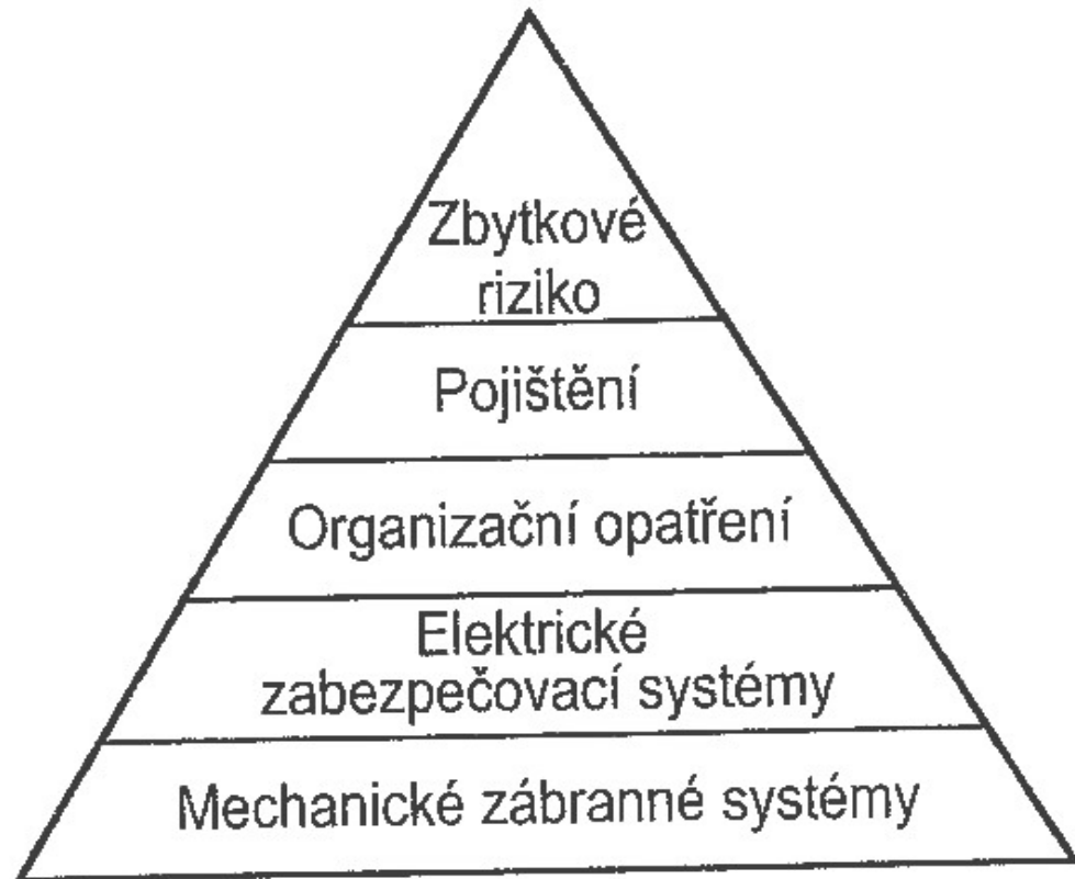
Obr. 5. Schéma systému bezpečnosti a ochrany majetku.
