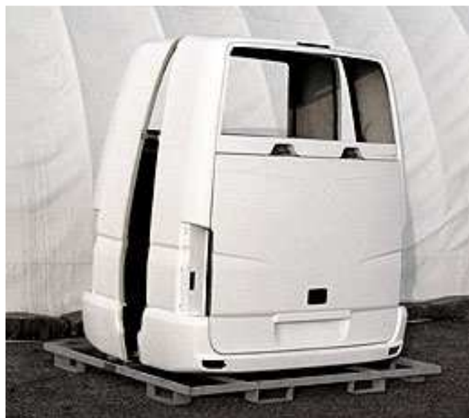
Obr. 6. Část karoserie tramvaje z laminátu [17]
