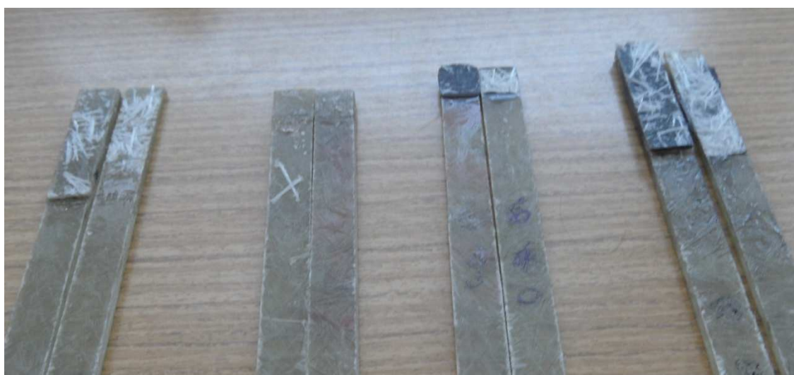
Obr. 57. Porušené vzorky po zkoušce na ohyb
