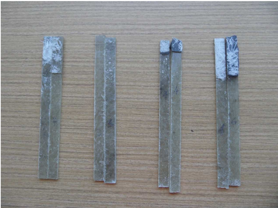
Obr. 33. Vzorky po porušení na trhače
