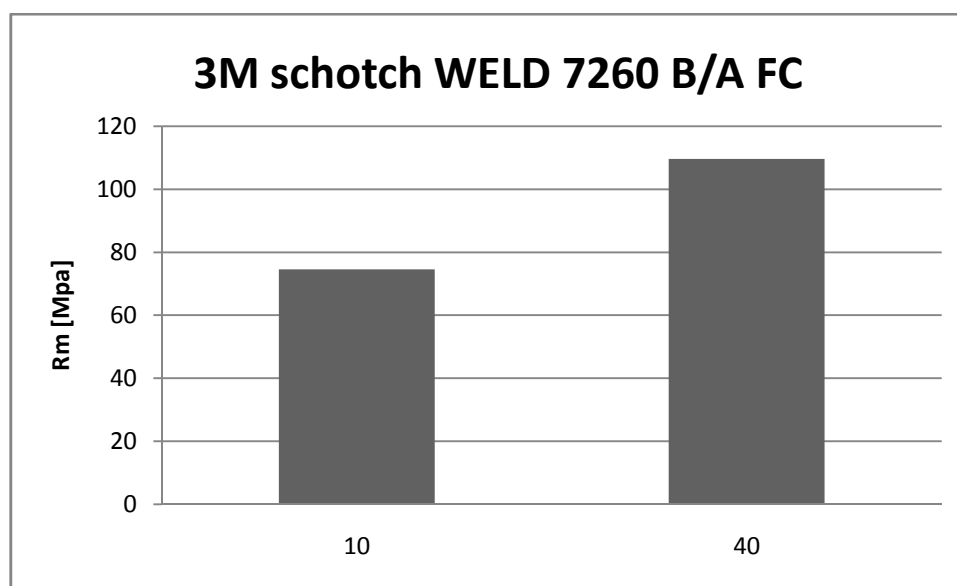
Obr. 39. Závislost únosnosti na překrytí
