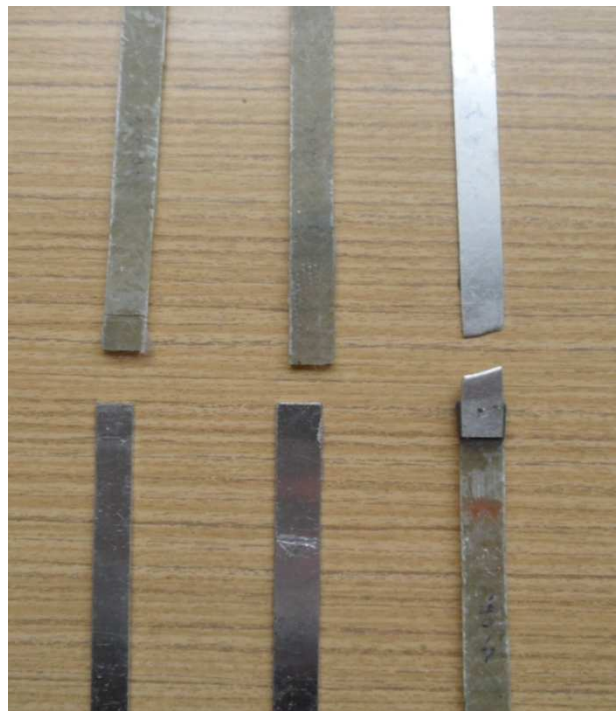
Obr. 35. Porušené vzorky po zkoušce na tah
