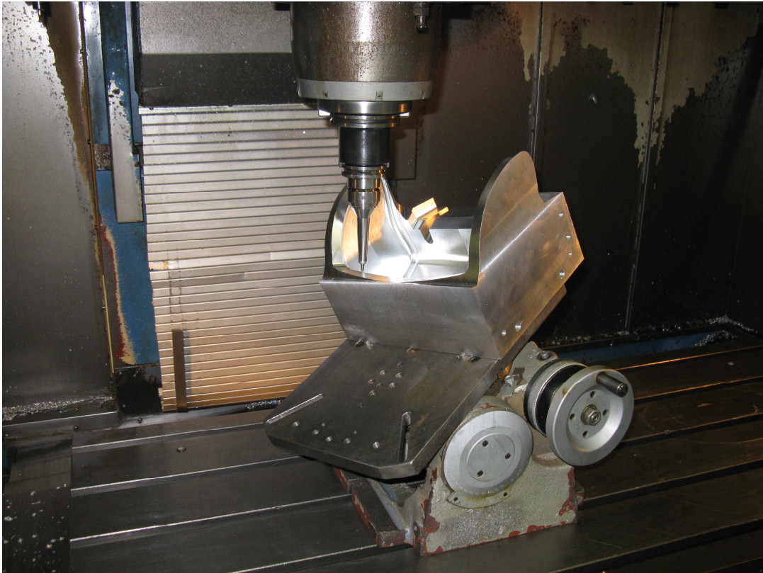
Obr. 31. Výroba tvaru pomocí otočně výklopného stolku TSK-250
