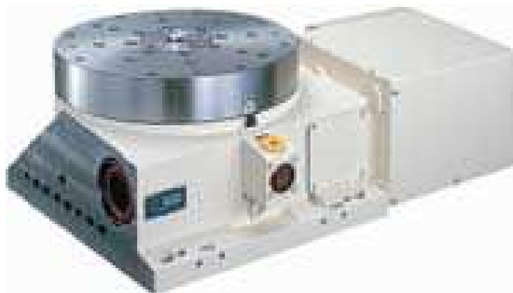
Obr. 23. Otočný stůl RC-300 Tsudakoma [16]
