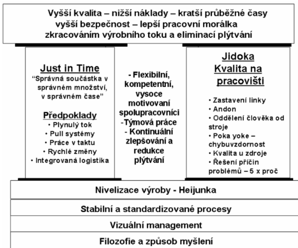
Obrázek č. 1.3: Výrobní systém Toyoty Zdroj: [4]
