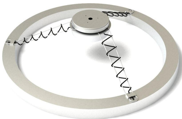
Obr. 19. Ukázka vedení kabelů
