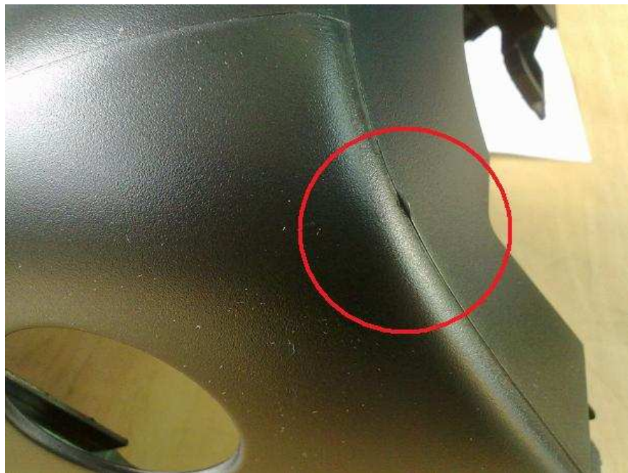
Obr. 37 Přetok v důsledku přeplnění kavitě spodního dílu.
