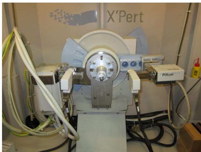
Obr. 26: Detail měřící hlavy stroje PANalytical X'Pert PRO.
