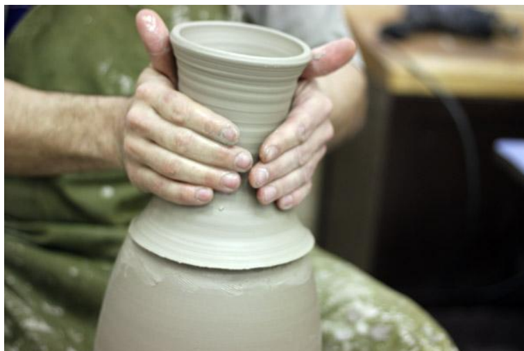
Obr. 71. Lepení polotovaru hrdla vázy.
