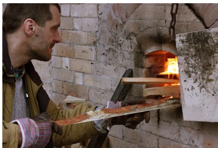
Obr. 83. Přikládání do bourry boxu.
