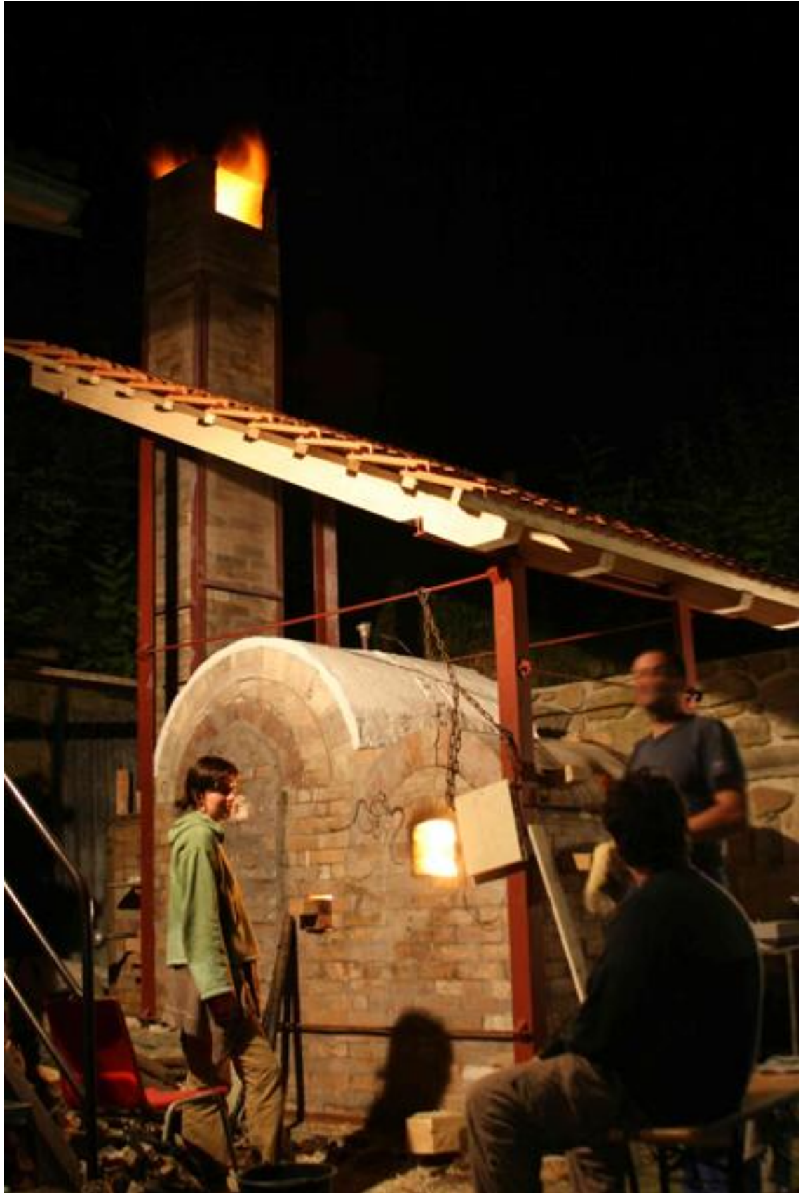
Obr. 51. Jednokomorová pec s bourry boxem, Besednice.
