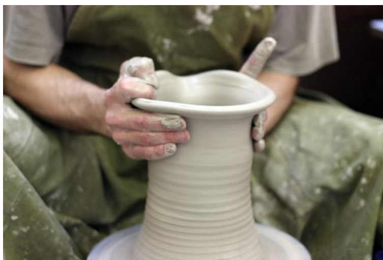
Obr. 70. Tažení základní kachlice.
