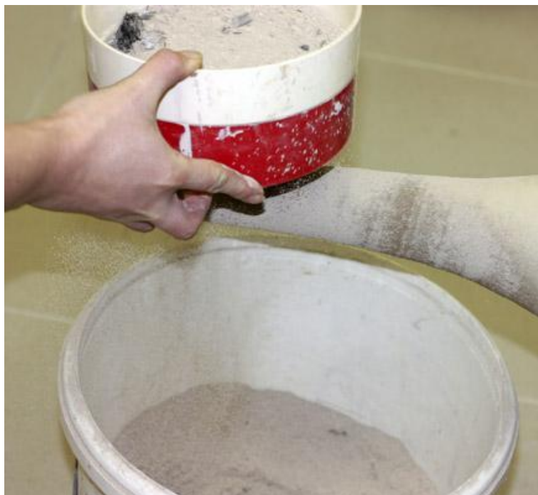
Obr. 80. Nanášení popela na hrdlo vázy.
