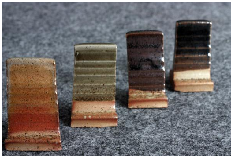
Obr. 77. Vypálené vzorky glazur.
