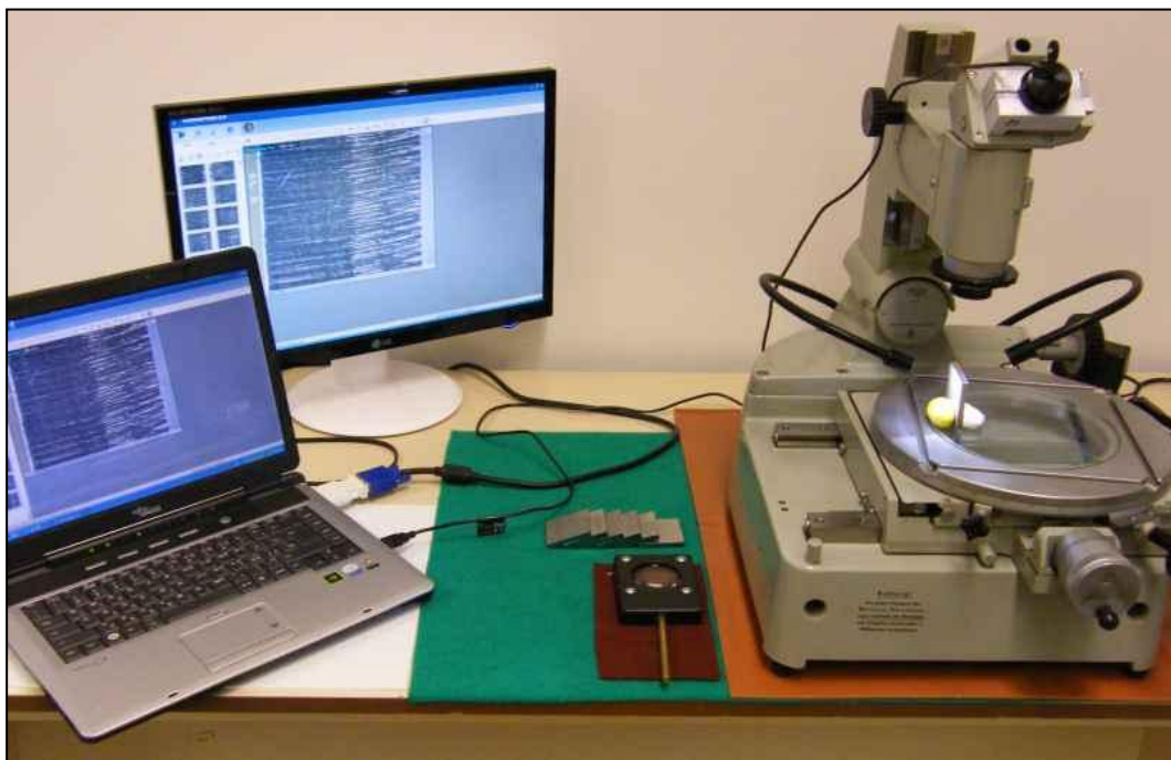
Obr. 43. Univerzální dílenský mikroskop – snímání povrchu vzorků
