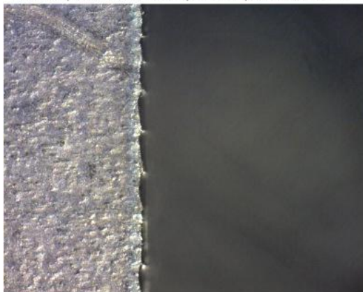
Hrana x po obrábění laserem při řezné rychlosti 2,8 m/min
