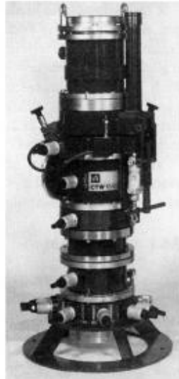
Obr. 25 - Schéma zařízení pro obrábění paprskem elektronů. [3]
