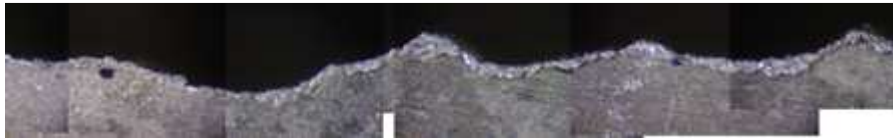
Obr. 56 - Nasnímaný povrch při měření pod mikroskopem – řez rychlostí 80%.
