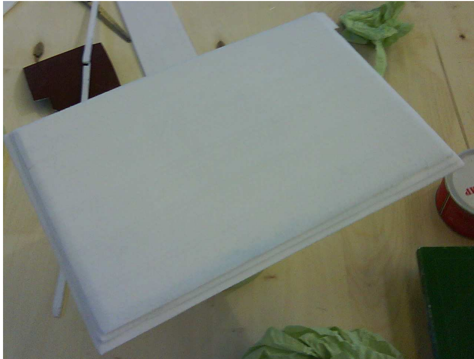
Obr. 52 - Desky PVC pěny připravené na výrobu sendvičových desek.
