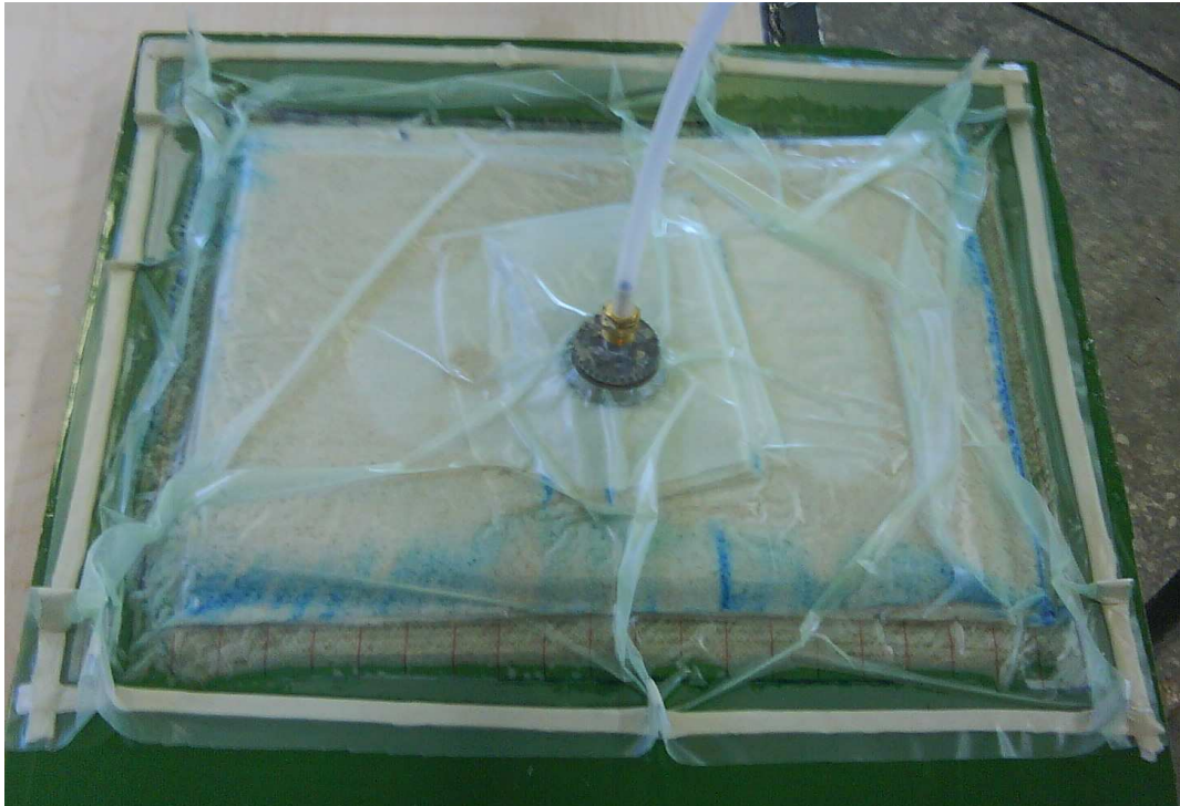
Obr. 53 - Lisování desky vakuem.
