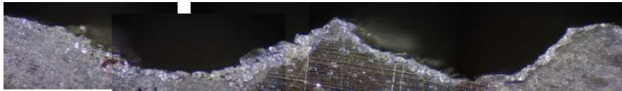
Obr. 57 - Nasnímaný povrch při měření pod mikroskopem – řez rychlostí 100%.
