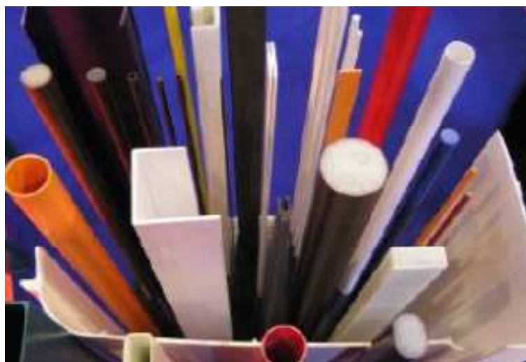
Obr. 35 - Profily vyrobené pultruzí. [20]
