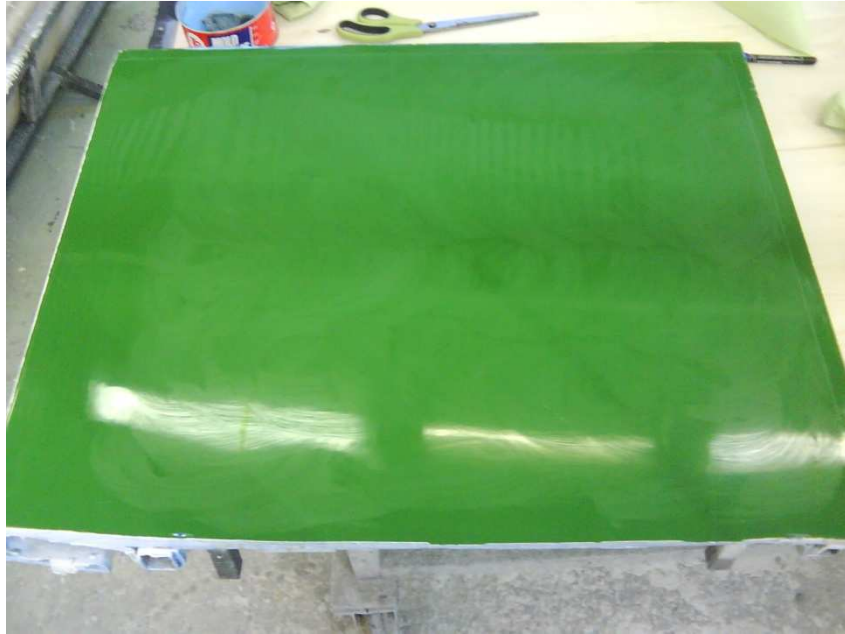
Obr. 51 - Forma potřená separačním přípravkem.
