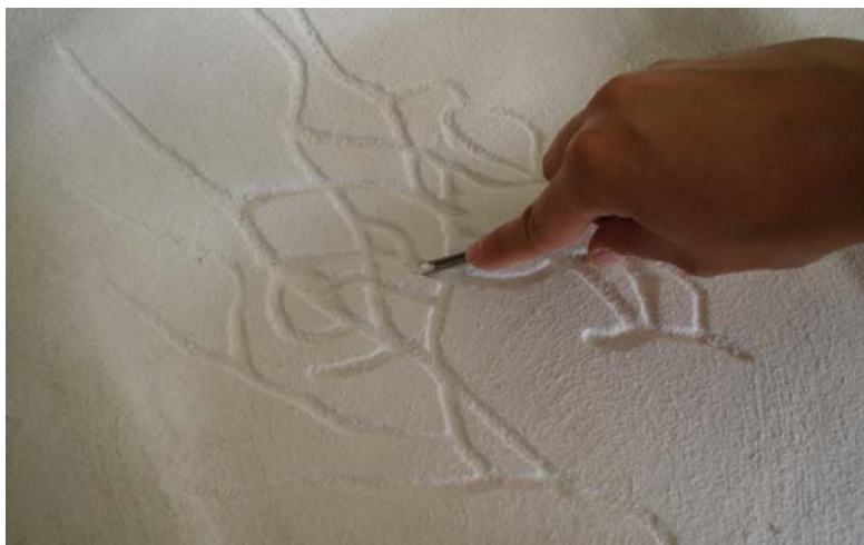
Obrázek 39., 40. Příprava sádrových forem na lehání skla
