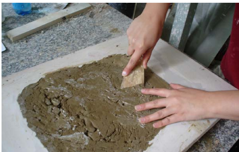
Obrázek 37., 38. Příprava sádrových forem na lehání skla
