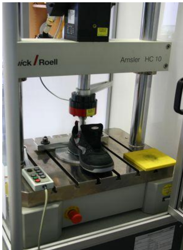
Obr. 3.11: Strojní zařízení AmslerHC 10, pro zkoušky hydraulickým zátěžovým namáháním. [75]
