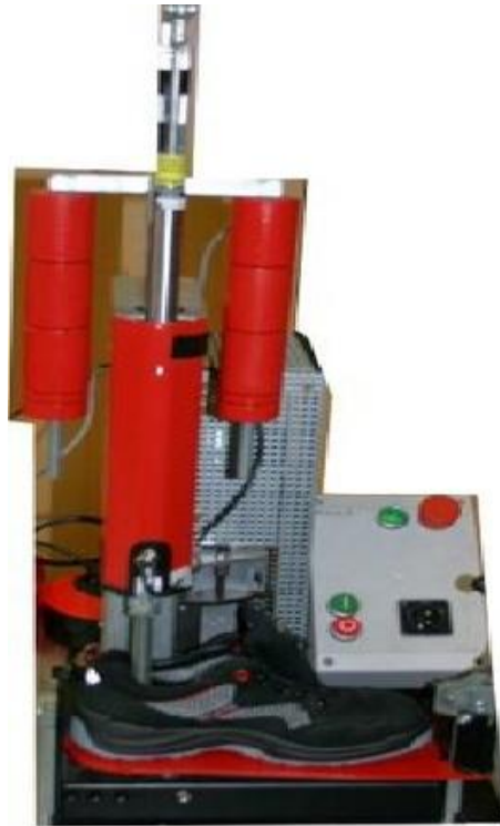
Obr. 3.10: Strojní zařízení Moeller, pro zkoušky padajícím závažím. [75]
