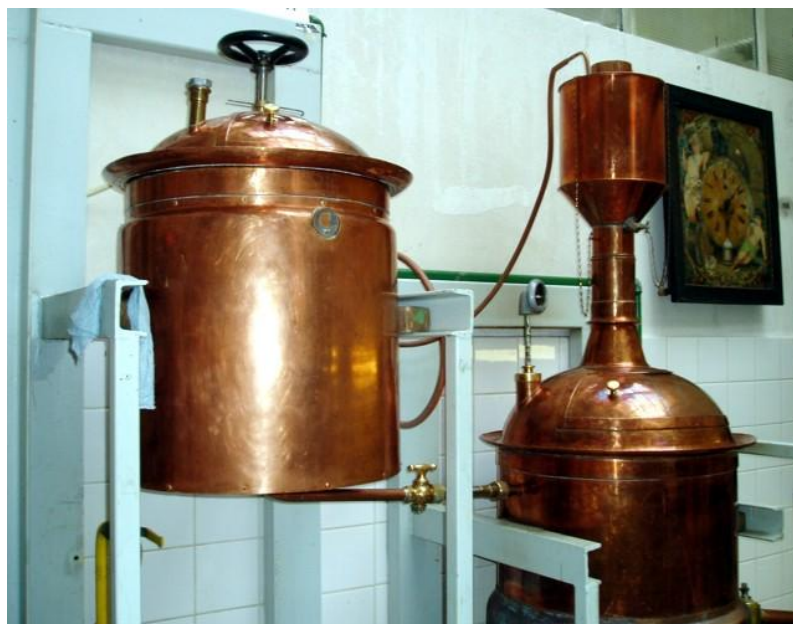
Obrázek 3: Scezovací kád' a mladinová pánev (Pivní.info, © 2003 - 2012)
