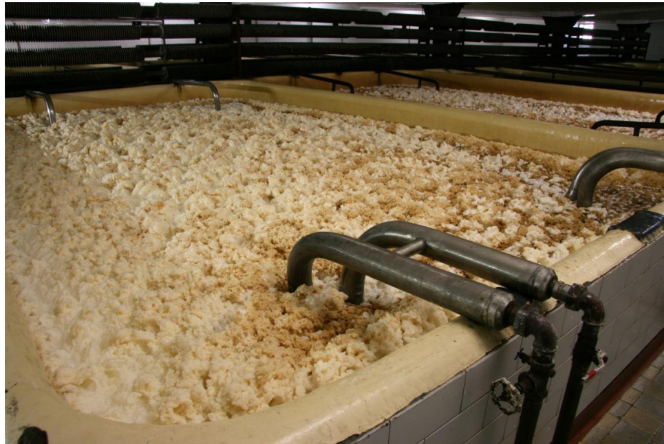
Obrázek 4: Hlavní kvašení mladiny (Pivovar Ferdinand, © 2010)
