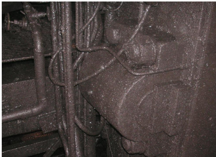
Obrázok 25: Nános usadenín na všetkých častiach stroja (vlastné spracovanie)
