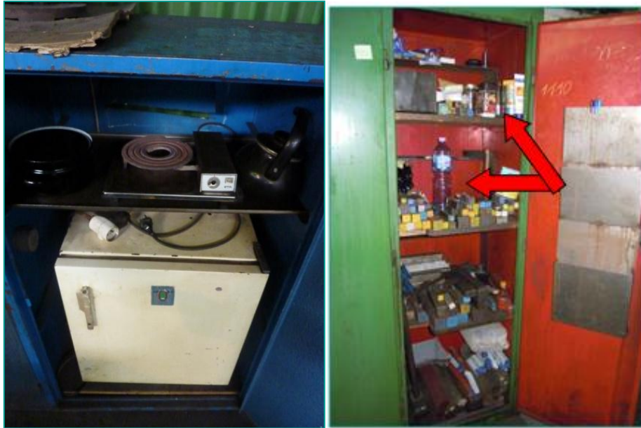
Obrázok 16: Nepotrebné veci na pracovisku, osobné veci sú zmiešané s pracovnými (vlastné spracovanie)
