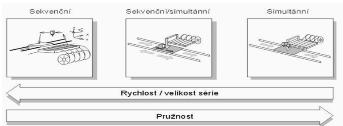
Obrázok 16 Vzťah medzi rýchlosťou a pružnosťou osádzovacích systémov
