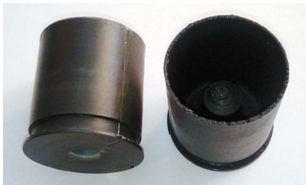
Obr. 35. Prototyp z F 16 s C prachem
