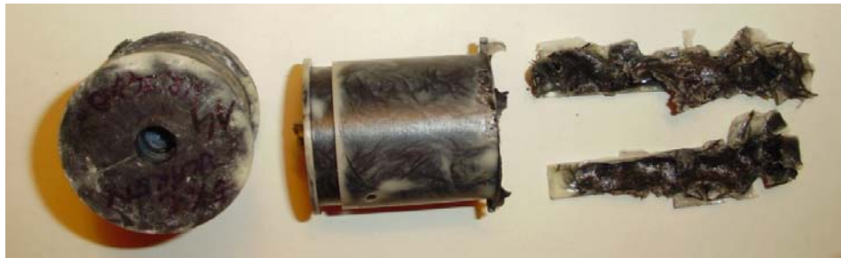
Obr. 41. Prototyp z UR 3490 s nasekaným uhlíkovým vláknem
