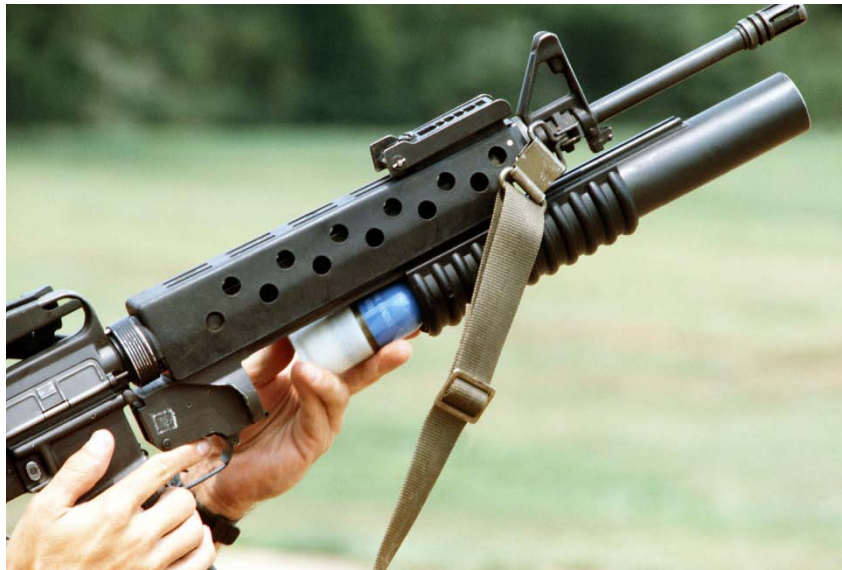
Obr. 4. Nabíjení 40mm cvičného náboje do granátometu M203.[6]
