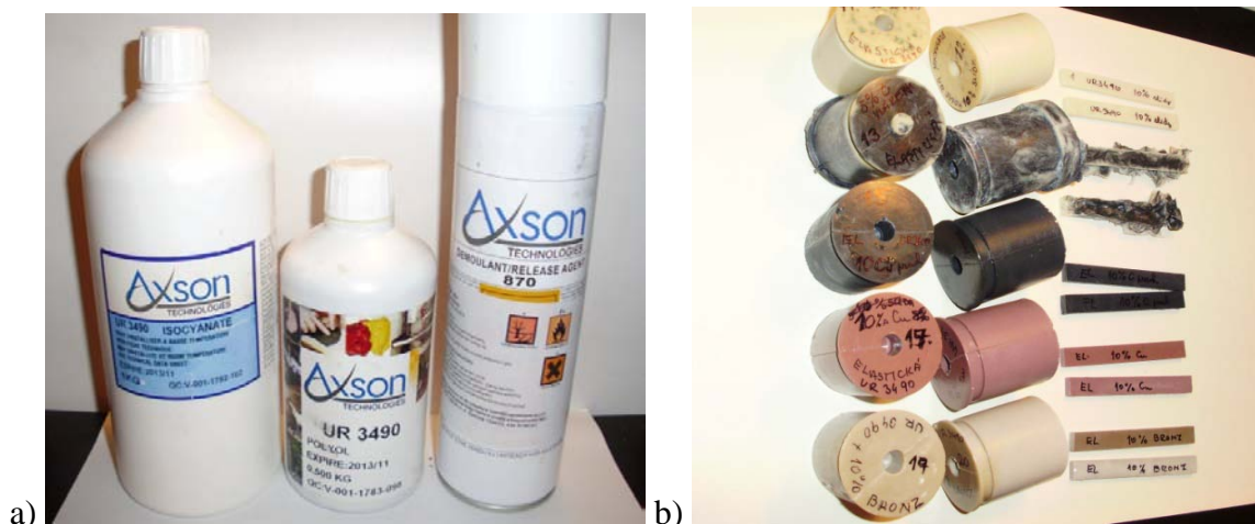
Obr. 39. a) Balení pryskyřice b) Odformované prototypy z UR 3490
