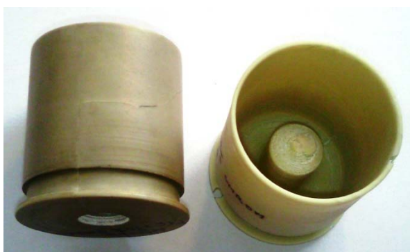
Obr. 38. Prototyp z F 16 s bronzovým práškem
