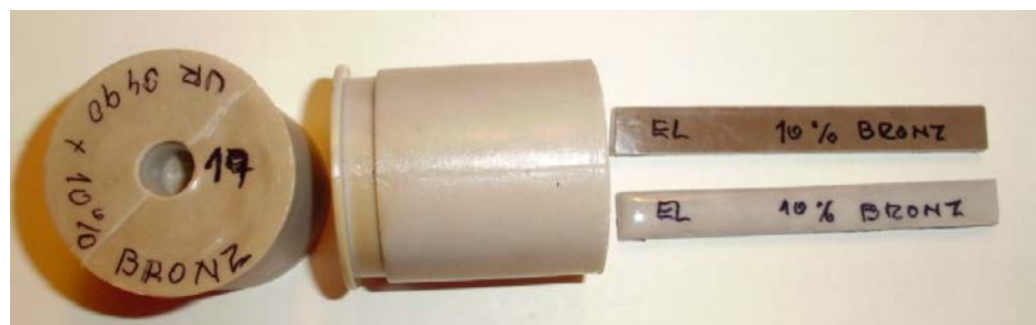
Obr. 44. Prototyp z UR 3490 s bronzovým práškem
