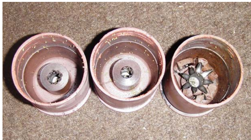
Obr. 73. Pohled na rozbitou komůrku nábojnice
