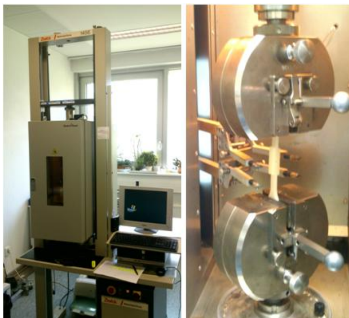
Obr. 29. Trhací stroj Zwick 1456 a detail upnutí vzorku.
