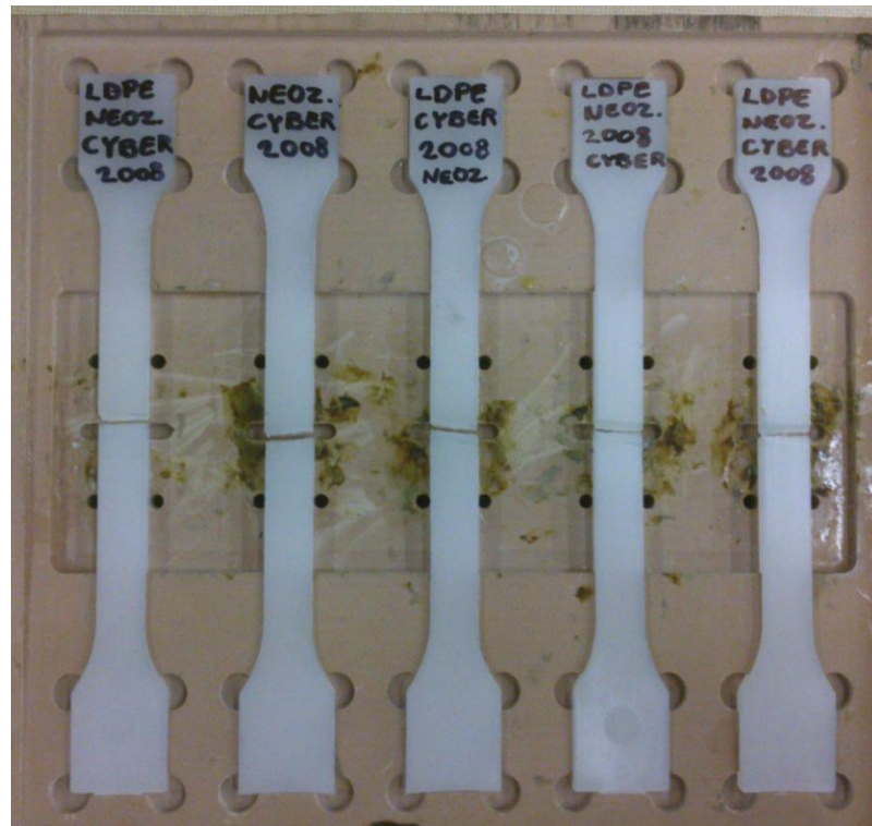
Obr. 27. Fixace zkušebních vzorků.
