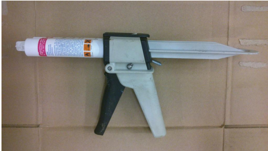
Obr. 18. Dávkovací pistole pro lepidlo Cyberbond A806.
