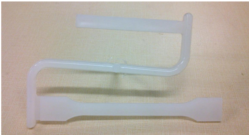
Obr. 19. Vystříknutý zkušební vzorek s obdélníkovým páskem pro přeplátování.
