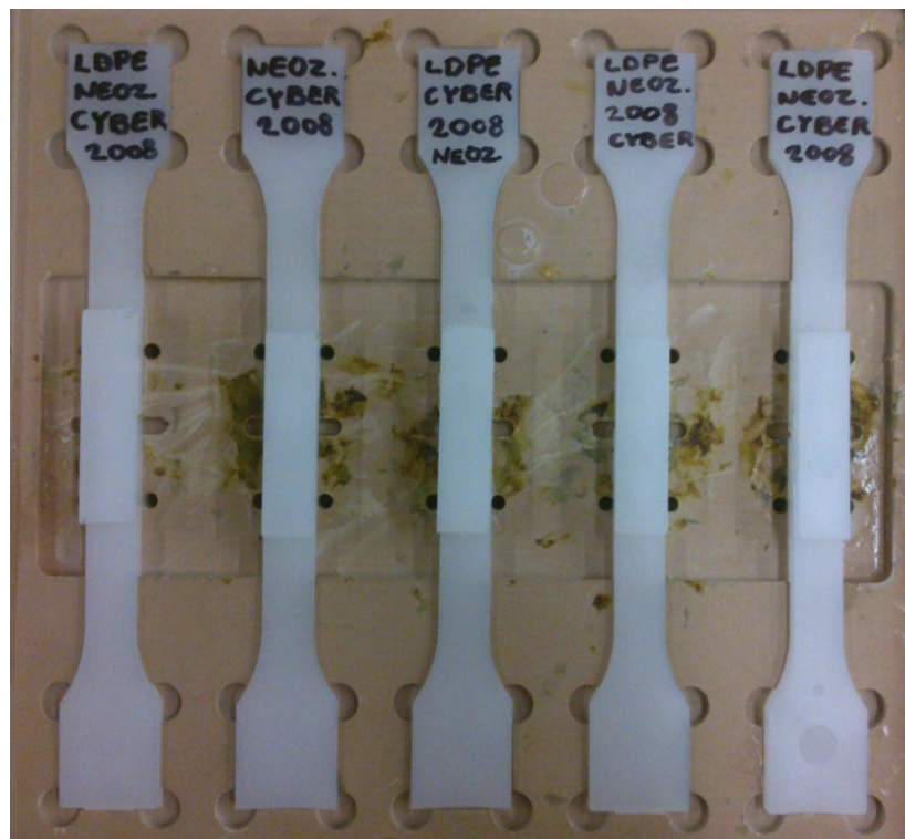
Obr. 28. Vytvrzování lepidla na manipulační pevnost.
