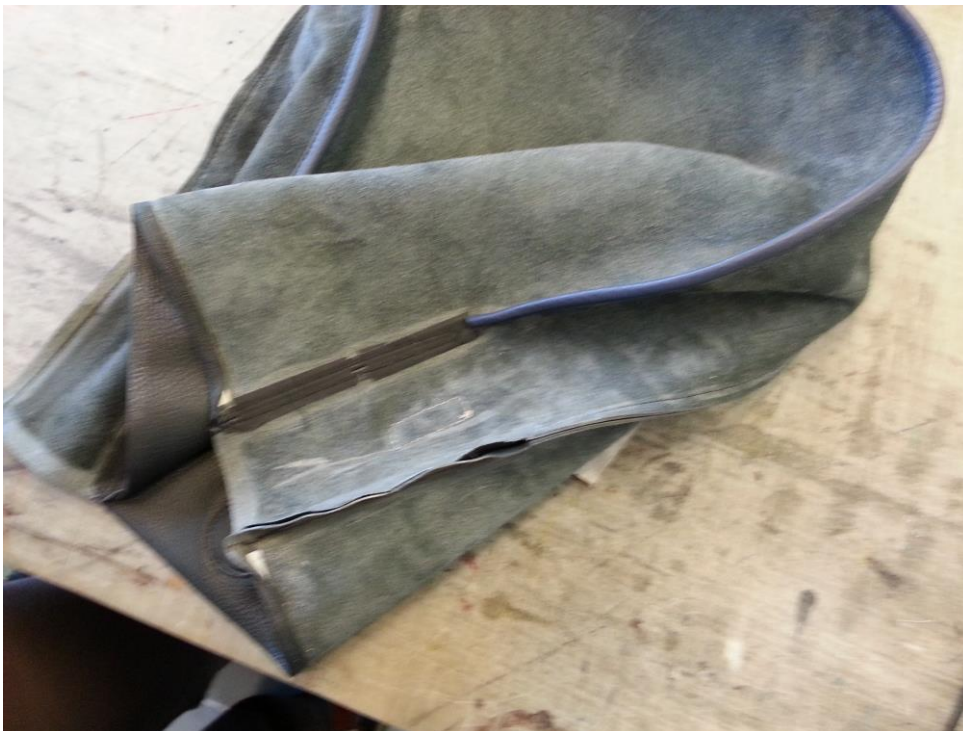
Obr. 56 Sešití hlavních dílů s věncem, zapravené švy francouzskou lemůvkou
