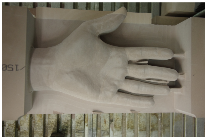
Obr. 115. Dlaňová strana po dokončování – upnutí č. 1
