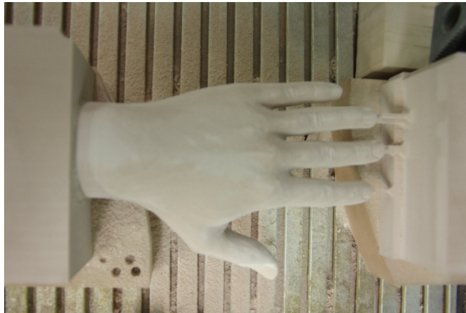
Obr. 118. Hřbetová strana po dokončování – upnutí č. 2
