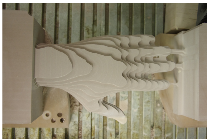
Obr. 117. Hřbetová strana po hrubování – upnutí č. 2
