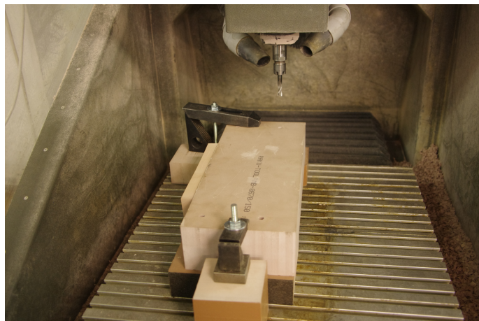
Obr. 113. Polotovaz – upnutí č. 1
