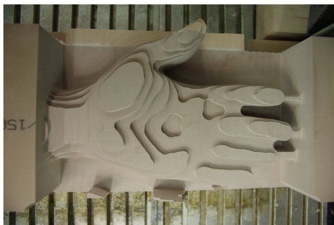
Obr. 114. Dlaňová strana po hrubování – upnutí č. 1
