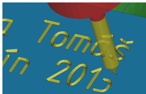
Obr. 112. Simulace obrábění – gravírování textu – prostředí NX 8.0
