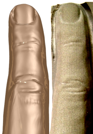
Obr. 108. Porovnání modelu prstu v prostředí NX 8.0 a obroběného modelu
