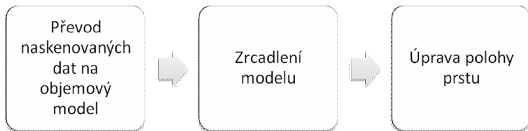
Obr. 77. Modelování a úpravy v programu CATIA
