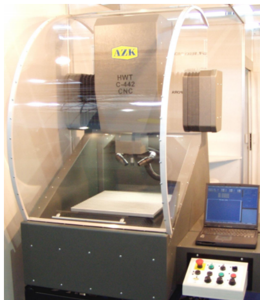
Obr. 105. Frézka AZK HWT 442
