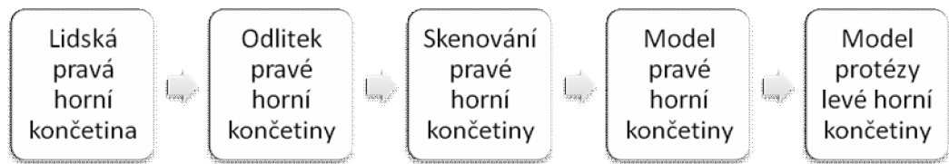
Obr. 97. Finální postup tvorby protézy levé horní končetiny
