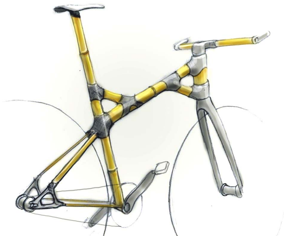
Obrázek 22: Kresba bambusového rámu s centrální trubkou a lamelovými prvky.
