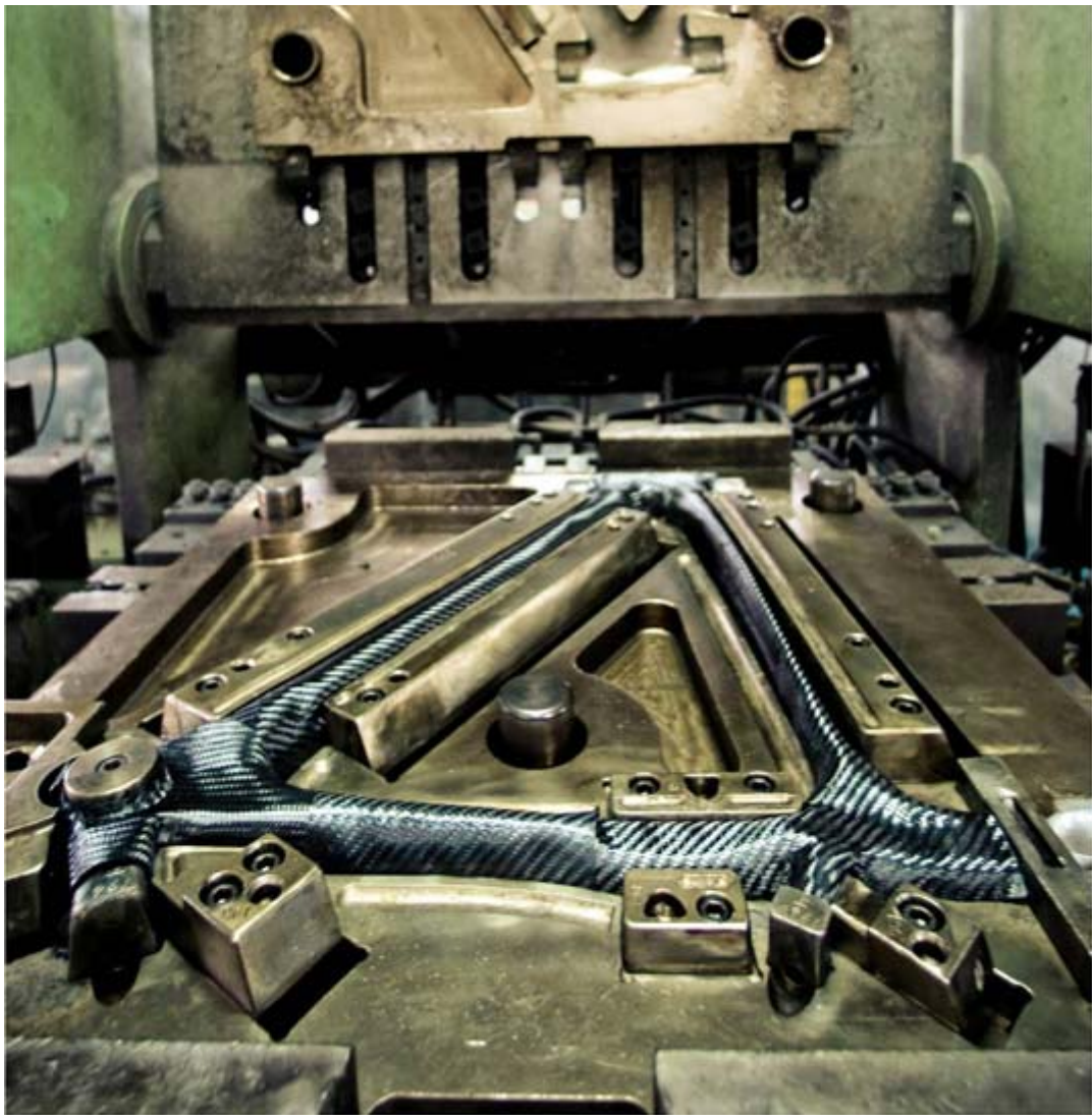
Obrázek 15: Monocoque karbonového rámu ve fázi před vyfukováním do formy.
