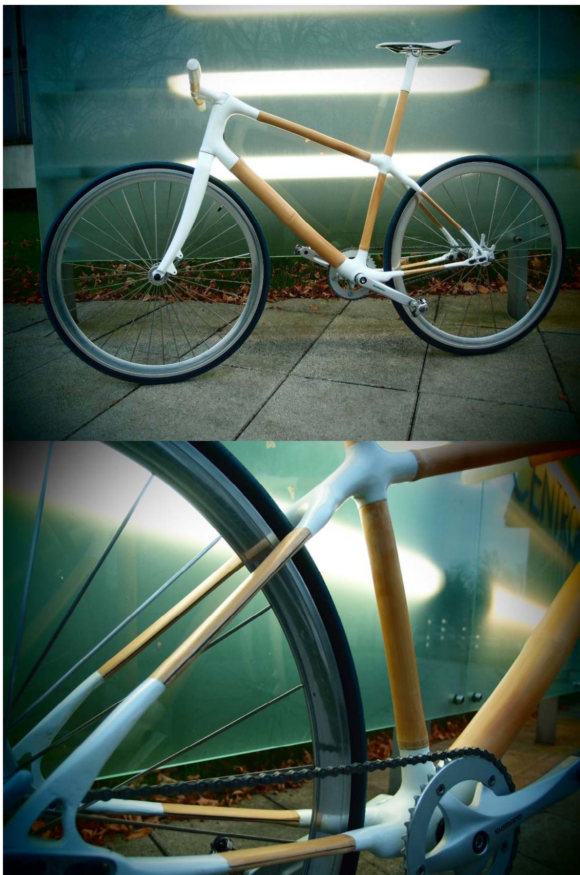
Obrázek 27: Realizace bambusového rámu s lamelovou zadní stavbou.
