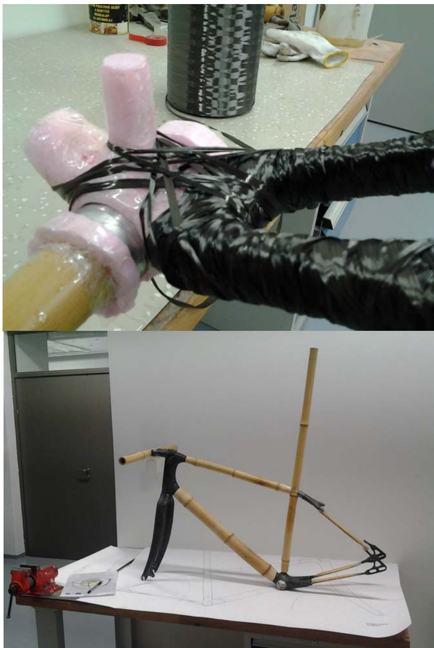
Obrázek 26: Laminování středové mufny a podoba bambusového rámu před slepením v geometrické stoličce.
