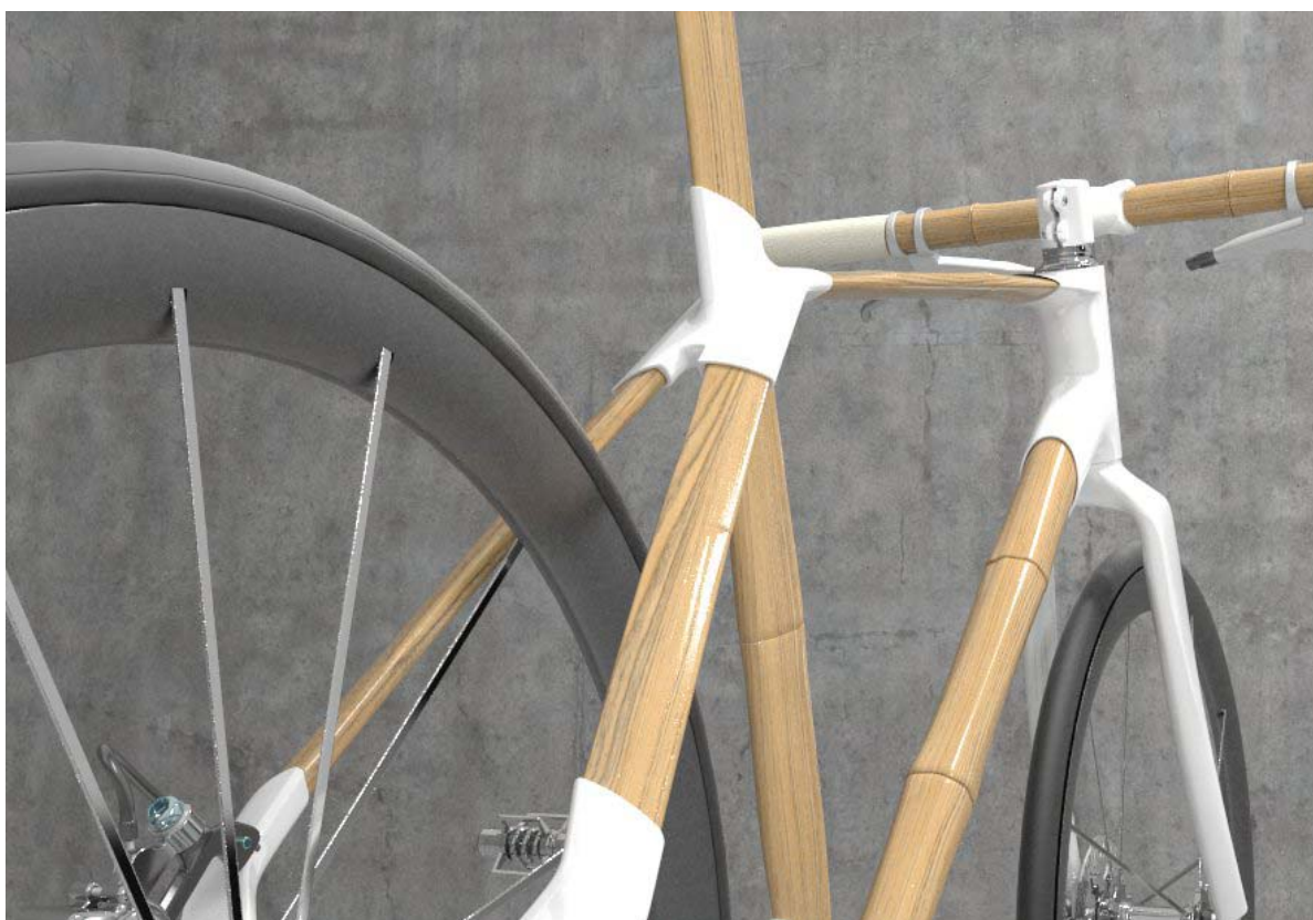
Obrázek 35: Detail lamelové zadní stavby.
