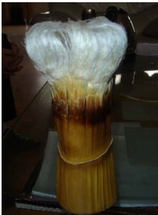
Obrázek 12: Rozvlákněná část bambusového stébla.
