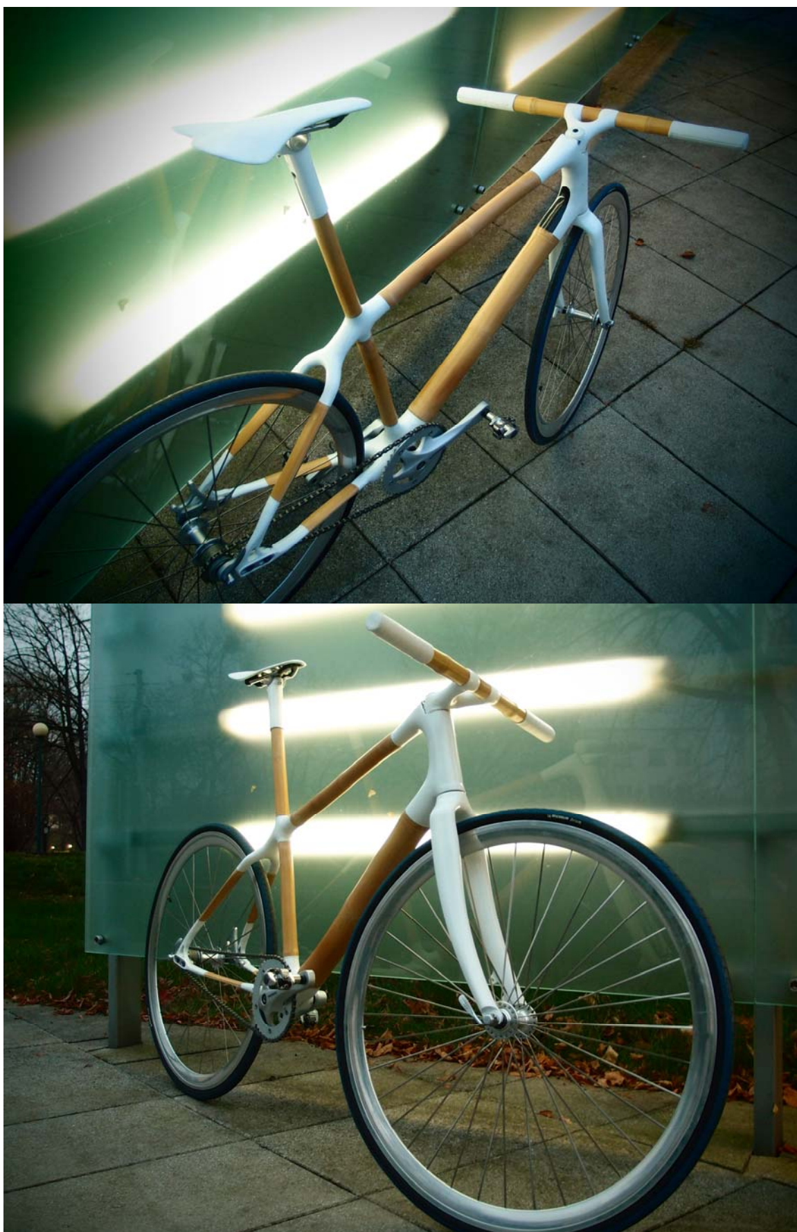
Obrázek 26: Realizace bambusového rámu s lamelovou zadní stavbou.
