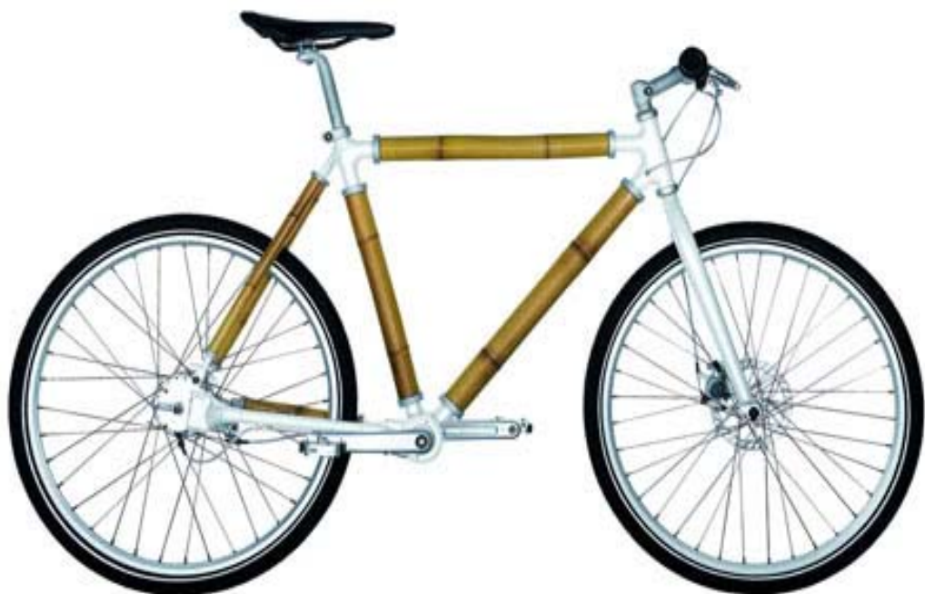
Obrázek 9: Bambusové kolo firmy Biomega se vyznačuje použitím hnací hřídele a bambusem spojeným ocelovými spojkama.
