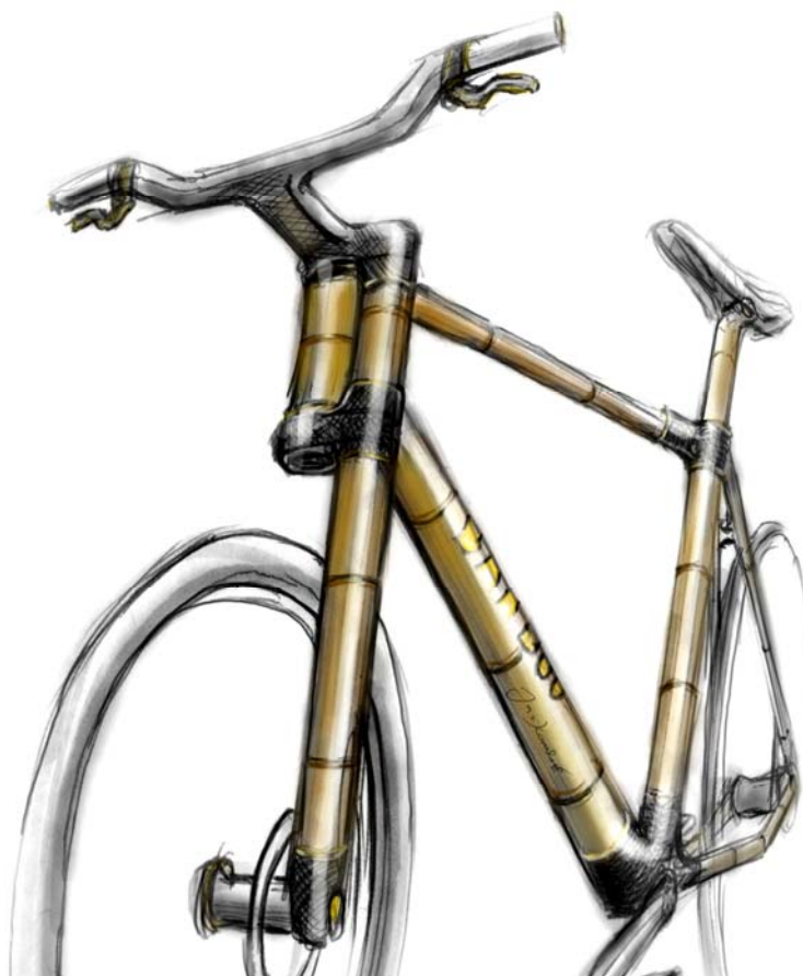
Obrázek 23: Kresba bambusového rámu s levostrannou vidlicí.
