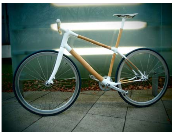
Obrázek 2: Slopingový rám vyznačující se dlouhou sedlovou trubkou.
