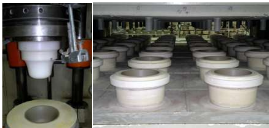
Obr. 82. „Roller Head Shaping“ a následné vysušování produktů v sušičce
