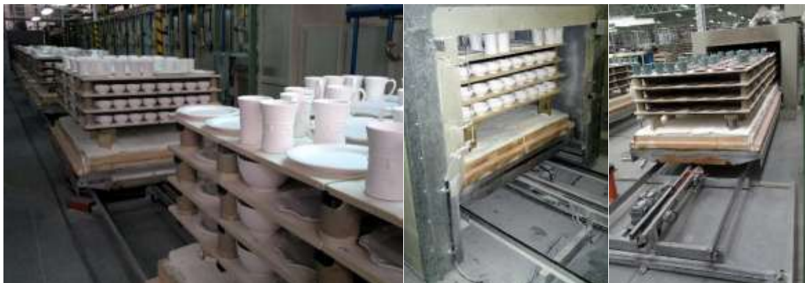
Obr. 88. Jednotlivé fáze výpalování v tunelové peci
