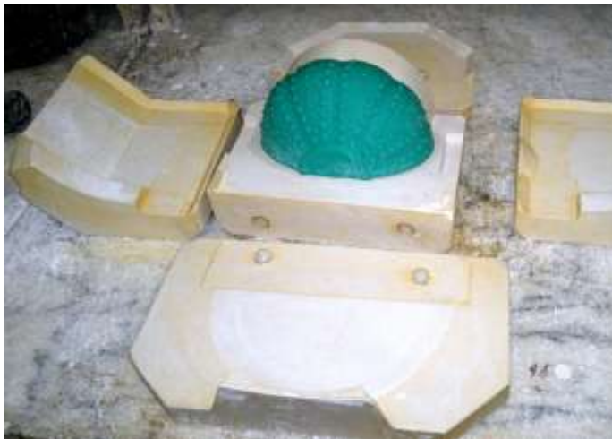
Obr. 79. Silikonová forma pro výrobu jemnějších detailů
