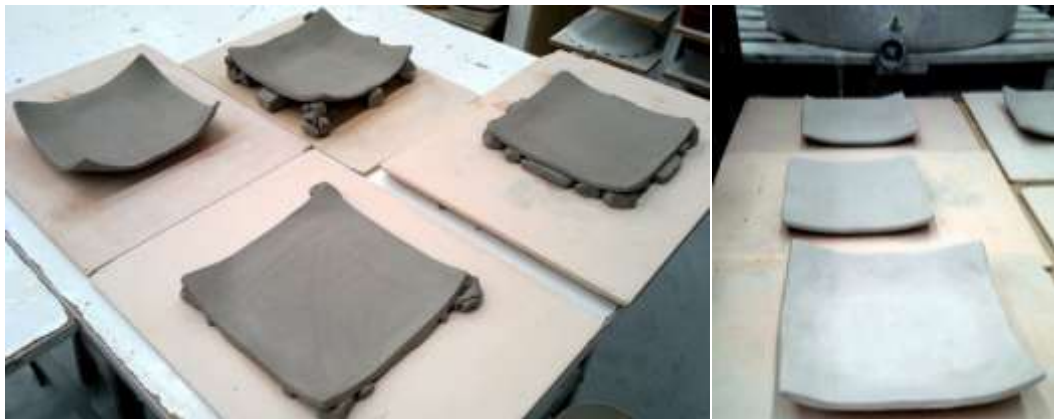
Obr. 117. Zkouška materiálu na zkušebních talířích
