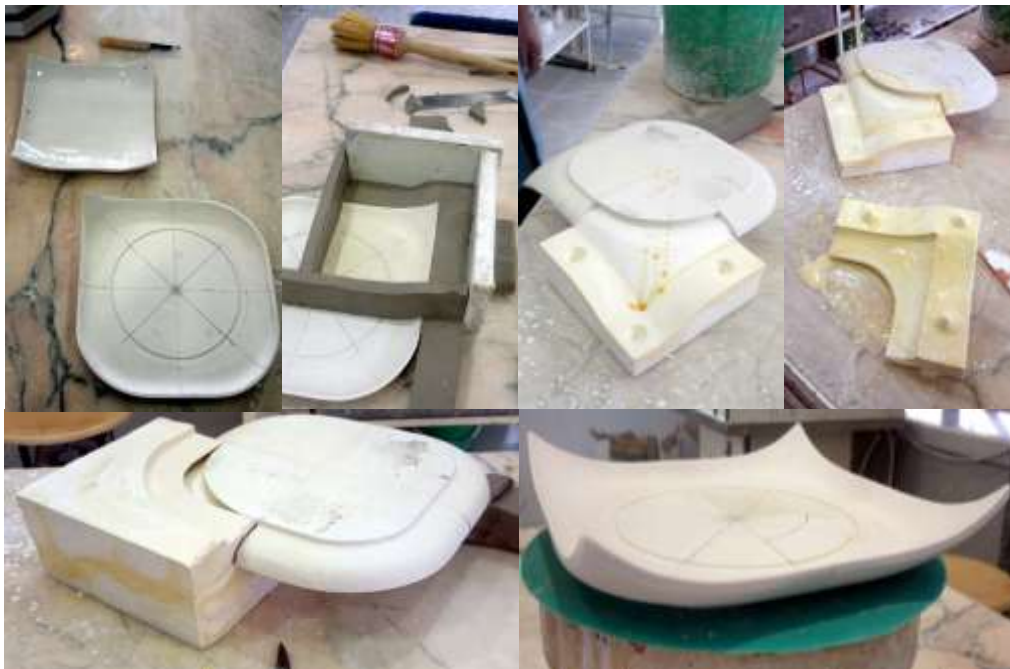
Obr. 120. Postup při výrobě sádrového prototypu
