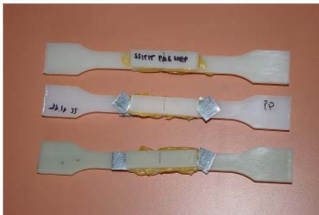
Obr. 24. Vytvrzující proces u 2K lepidel s ukázkou distančních vložek
