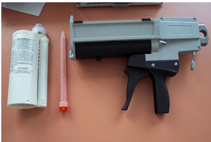
Obr. 21. Speciální pistolový aplikátor se statickým mixérem pro nanášení 2K lepidel
