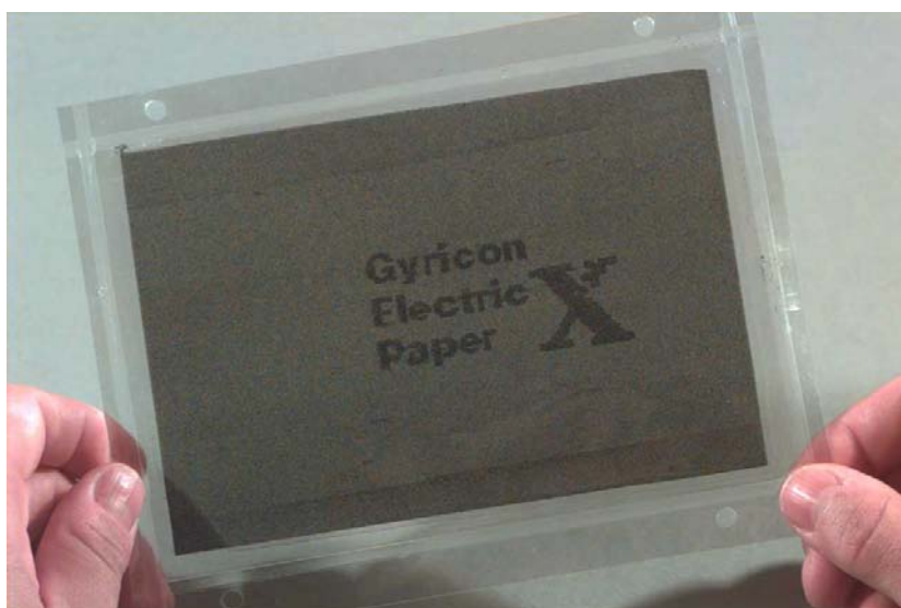
Obr. 2. První elektronický papír - Gyricon
