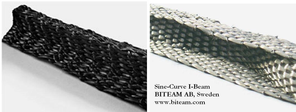
Obr. 7-1 3D tkaná profilovaná výstuž pre nosné kompozitné materiály
