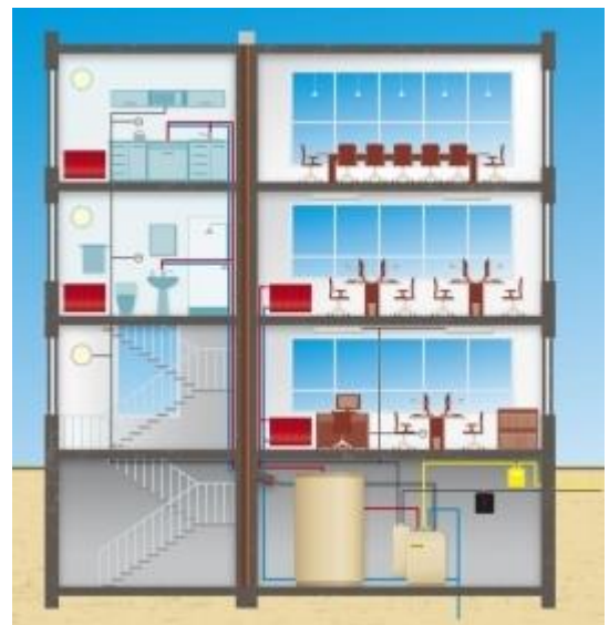
Obrázek 4 Využití kogenerační jednotky pro vytápění (TEDOM)
