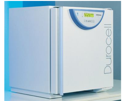
Obr.12 Sušárna s cirkulací vzduchu
