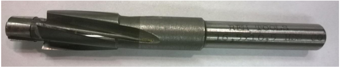
Obr. 61. Použitý válcový záhlubník 16,5x10,5 mm
