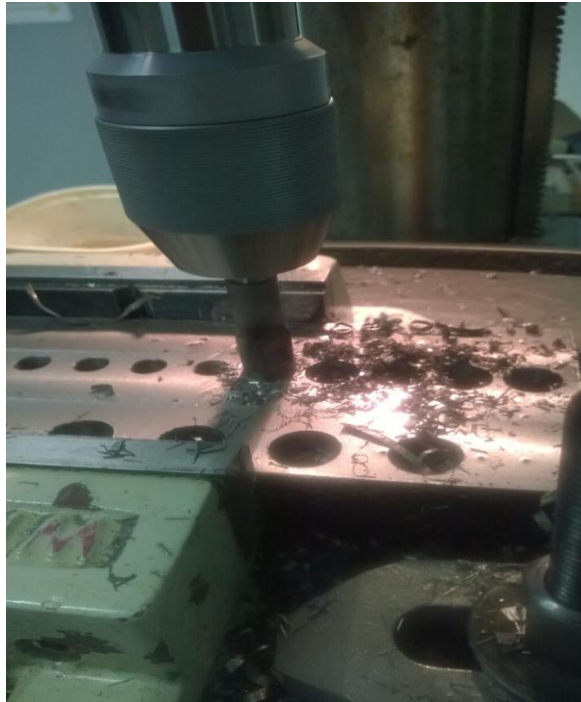
Obr. 66. Zahlubování záhlubníkem ČSN 22 1604, 16,5x10,5 mm
