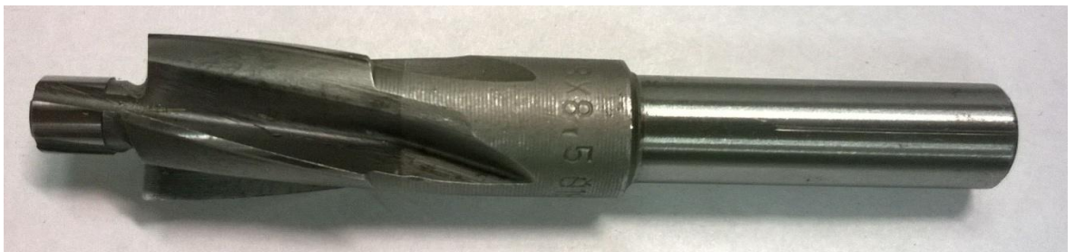
Obr. 60. Použitý válcový záhlubník 18x8,5 mm
