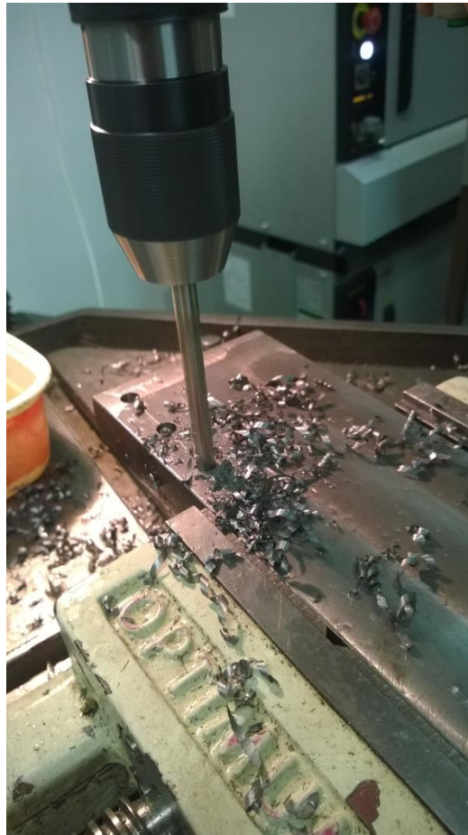
Obr. 59. Provedení vrtání v praxi
