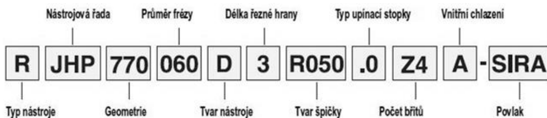
Obr. 44 Označení fréz od firmy Seco Tools [15]
