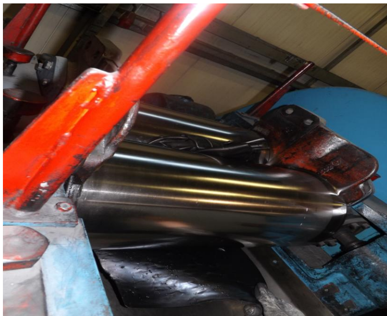
Obr. 16. Příprava směsi na dvouválci
