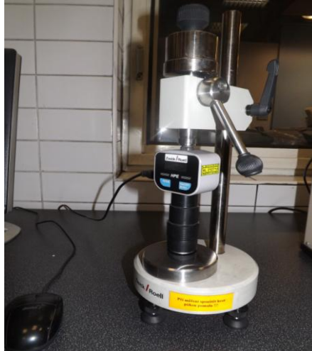
Obr. 21. Měření tvrdosti Shore A
