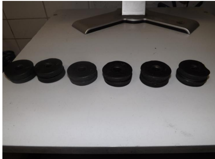
Obr. 19. Testovací tělíska pro Mooney MV 2000
