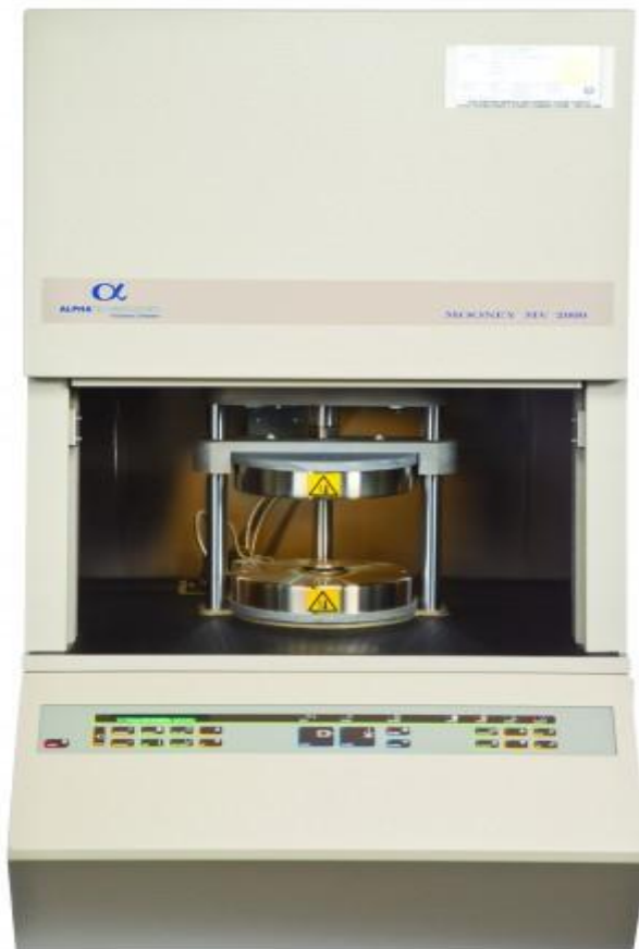
Obr. 5. Viskozimetr Mooney MV 2000 [10]
