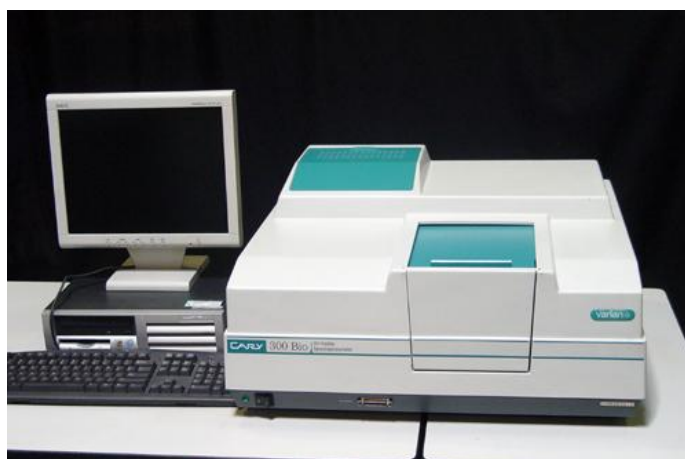
Obr. 25. Cary 100/300 UV-VIS spektrofotometr – Varian. [41]
