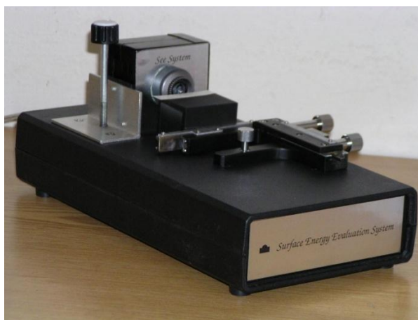
Obr. 24. SeeSystem na měření kontaktních úhlů. [39]
