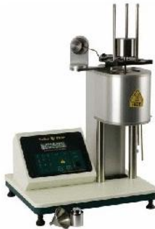
Obr. 15. Výtlačný plastometr model MP600. [25]
