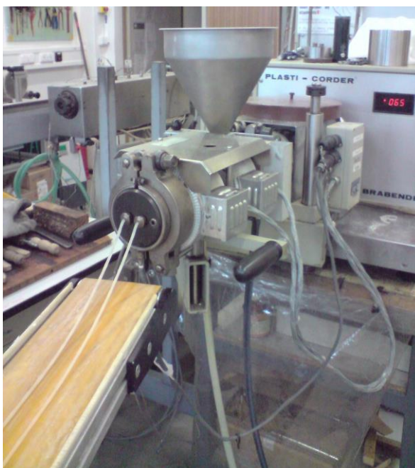
Obrázek 7: Dvoušnekový extrudér - homogenizace vzorku
