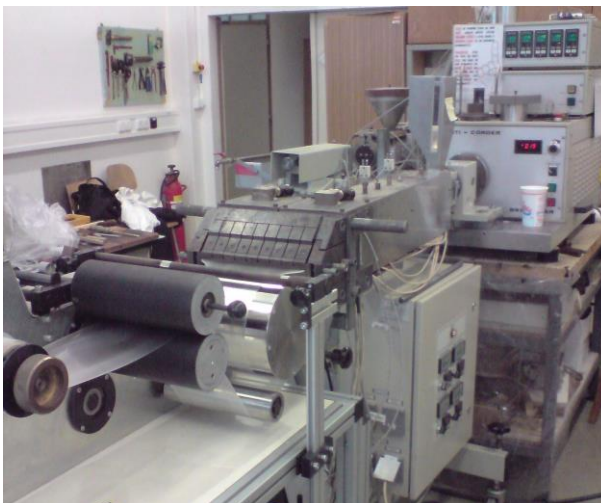
Obrázek 9: Vytlačování fólií na širokoštěbinové hlavě
