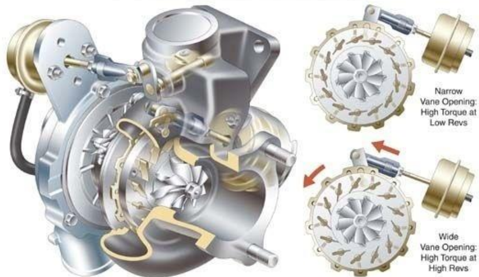
Obrázek 3 – Řez turbodmyhadla s regulací za pomoci VNT (převzato z [12])
