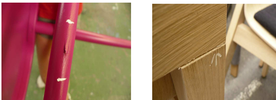
Obrázek 16 Nekvalita z montáže vyřazena až po konečném opracování na středisku dokončení (vlastní zpracování)
