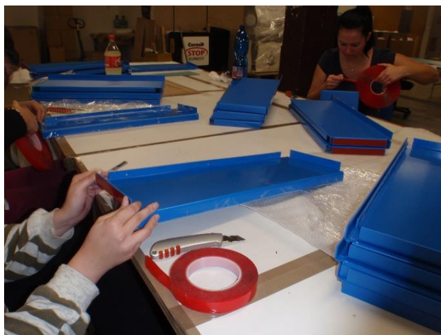
Obr. 20. Pracoviště olepování polic oboustrannou páskou (vlastní zpracování)
