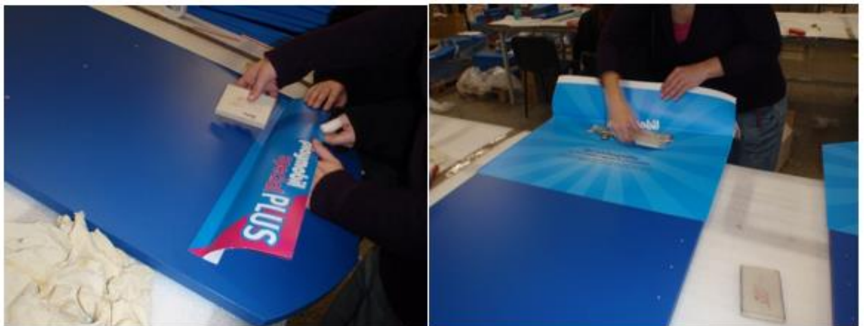
Obr. 21. Olepování těla stojanu vinylovými nálepkami (vlastní zpracování)
