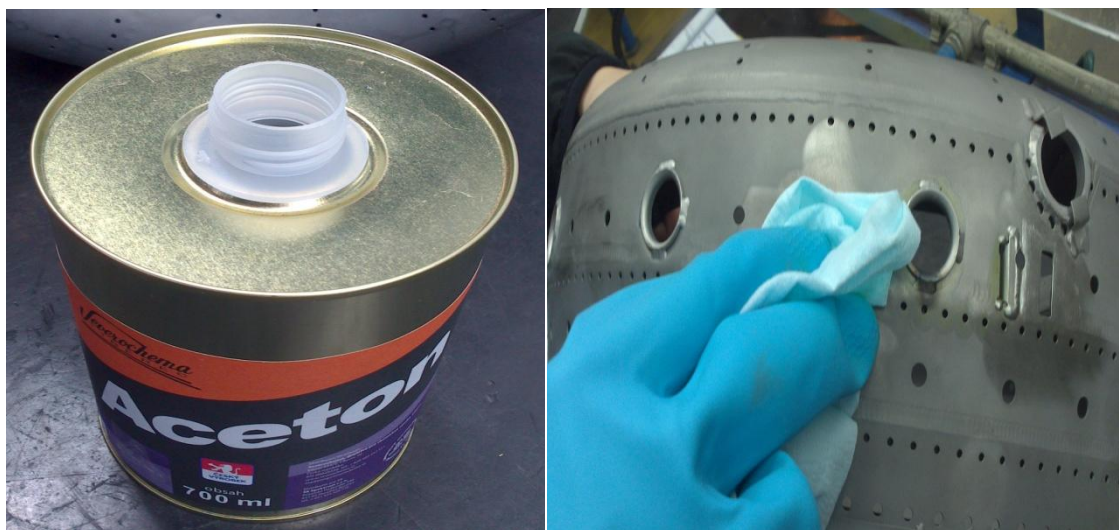
Obr. 22. Čistící prostředek a čištění dílce (vlastní zpracování)
