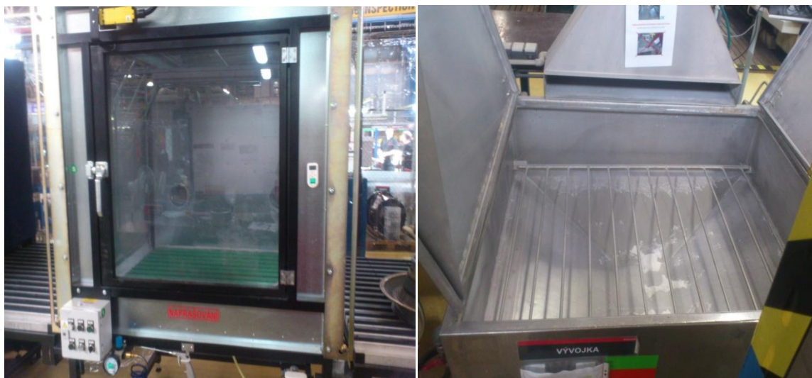
Obr. 30. Srovnání velikostí vývojky na nové a staré lince (vlastní zpracování)
