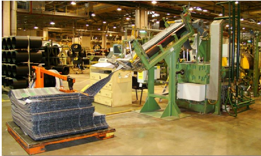
Obr. 19 – Odoberanie zmesi z palety do vytlačovacieho stroja (vlastné spracovanie)
