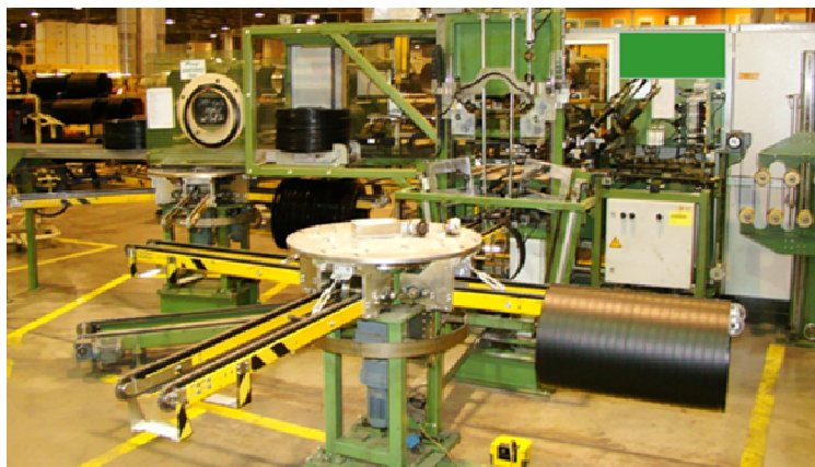
Obr. 23 – Karuselový zásobník (vlastné spracovanie)
