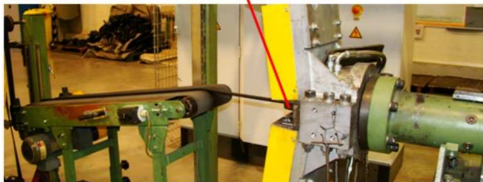
Obr. 20 – Náhľad na vytlačovaciú hlavu extrudéra (vlastné spracovanie)
