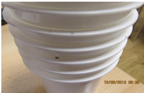
Obr. 36 Nečistoty v téglíkoch (nečistota na fólii)
