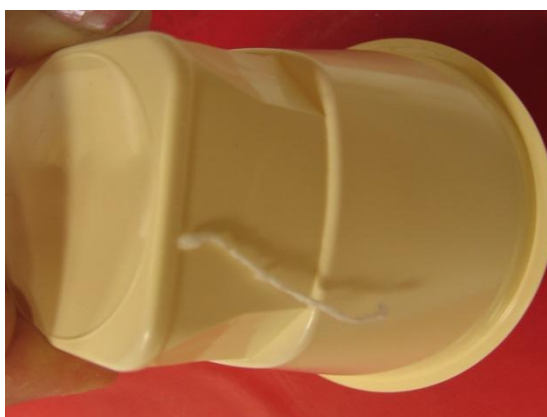
Obr. 41 Cudzí predmet na téglíku (kontaminácia pri čistení stroja handrou)
