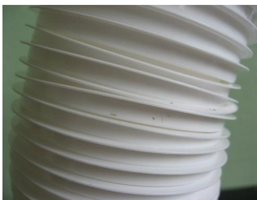
Obr. 43 Sklady na téglíku (prehriata fólia, vypadávanie fólie z vedenia)
