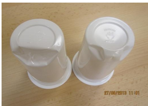
Obr. 44 Zalisované téglíky (nalepenie téglíku na vyhadzovák)
