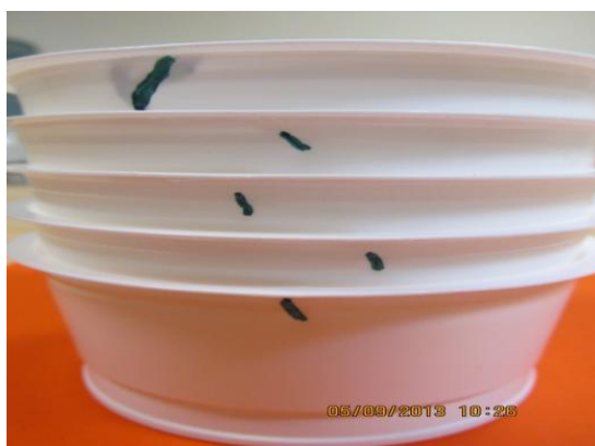
Obr. 39 Zlepené a zdeformované téglíky (zlé štósovanie)
