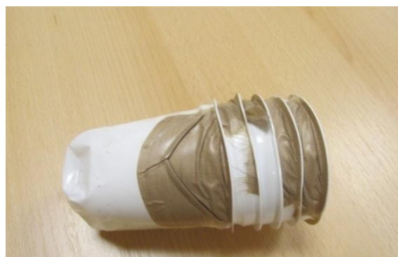
Obr. 38 Teflonová páska na téglíkoch (odlepenie pásky medzi strojom a pecou)
