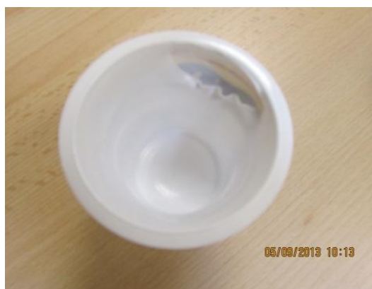
Obr. 40 Mäkké dná téglíkov (nalepený kolík na preťahovači alebo špatný ventil)
