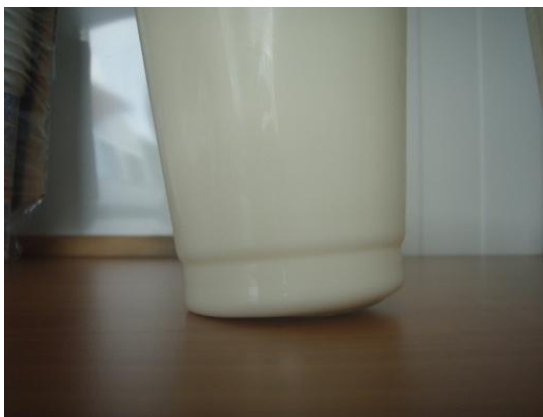
Obr. 42 Nedotvarované dná téglíkov (nízka teplota alebo ochladenie od formy)
