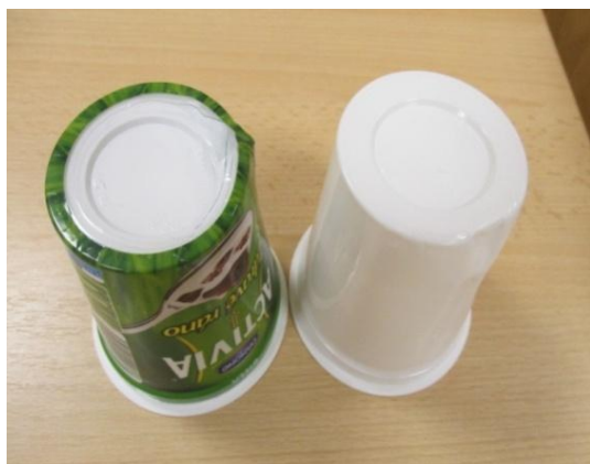
Obr. 50 Zle rozvrstvený materiál (zlé nastavenie teploty, krivá tyčka na štempli)
