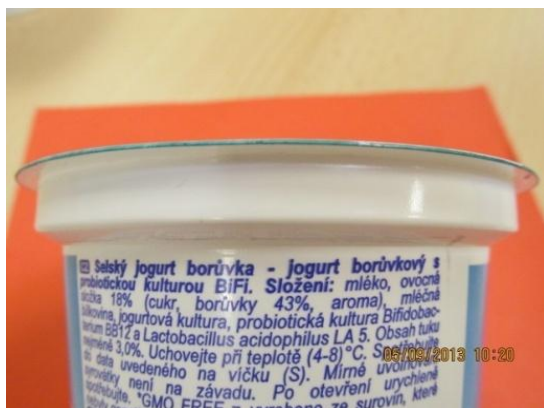
Obr. 48 Tenký lem na téglíku (vysoká teplota na stroji a povolený kalibračný krúžok)
