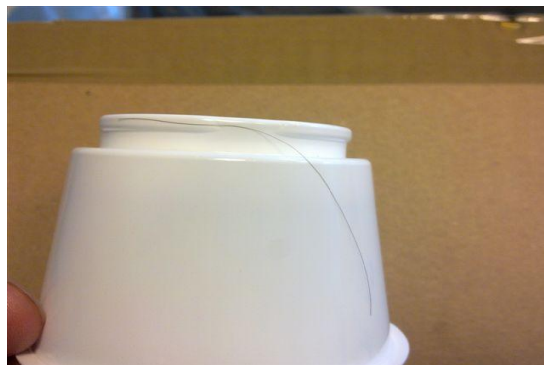
Obr. 35 Vlas na téglíku (zlé nosenie čiapky obsluhou stroja)
