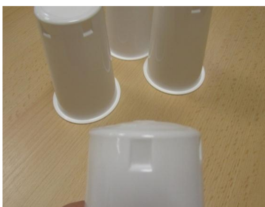
Obr. 45 Vypuklé dná téglíkov (preťahovače sa dotýkajú dna)
