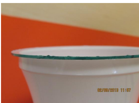
Obr. 46 Výstupky na leme (poškodený kalibračný kúžok, prehriata fólia)
