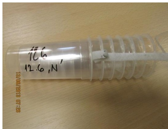
Obr. 49 Suchý zips na téglíkoch (odlepenie suchého zipsu zo stroja)
