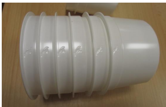
Obr. 37 Nečistoty v téglíkoch (prilepená nečistota na tvarovacej vložke)
