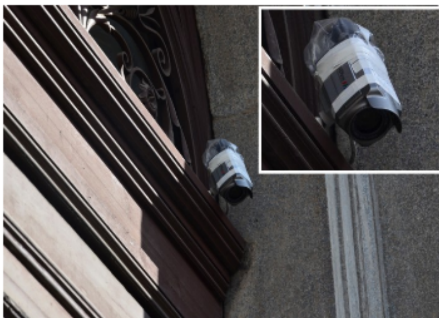
Obr. 16 Kamera s ručně vyrobeným krytím IP [34]
