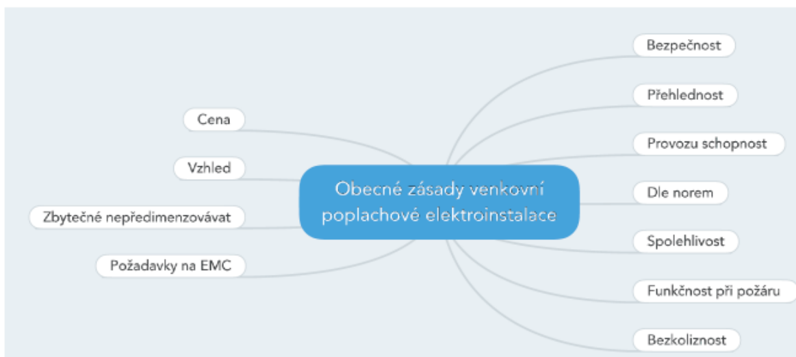
Obr. 7 Obecné zásady na venkovní poplachovou elektroinstalaci
