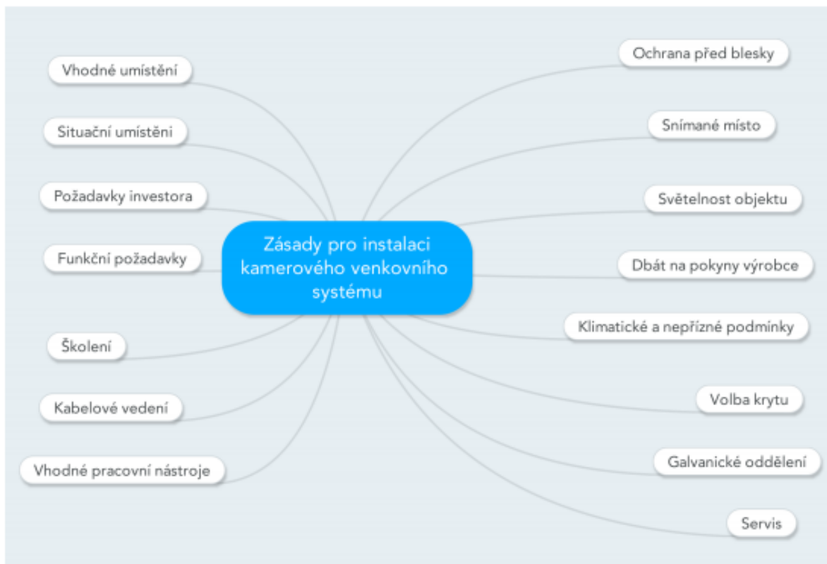
Obr. 8 Zásady pro instalaci kamerového venkovního systému
