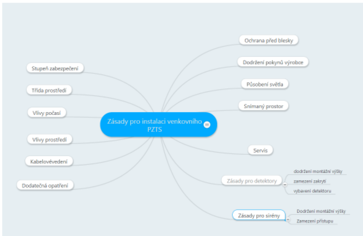
Obr. 10 Zásady pro instalaci venkovního PZTS
